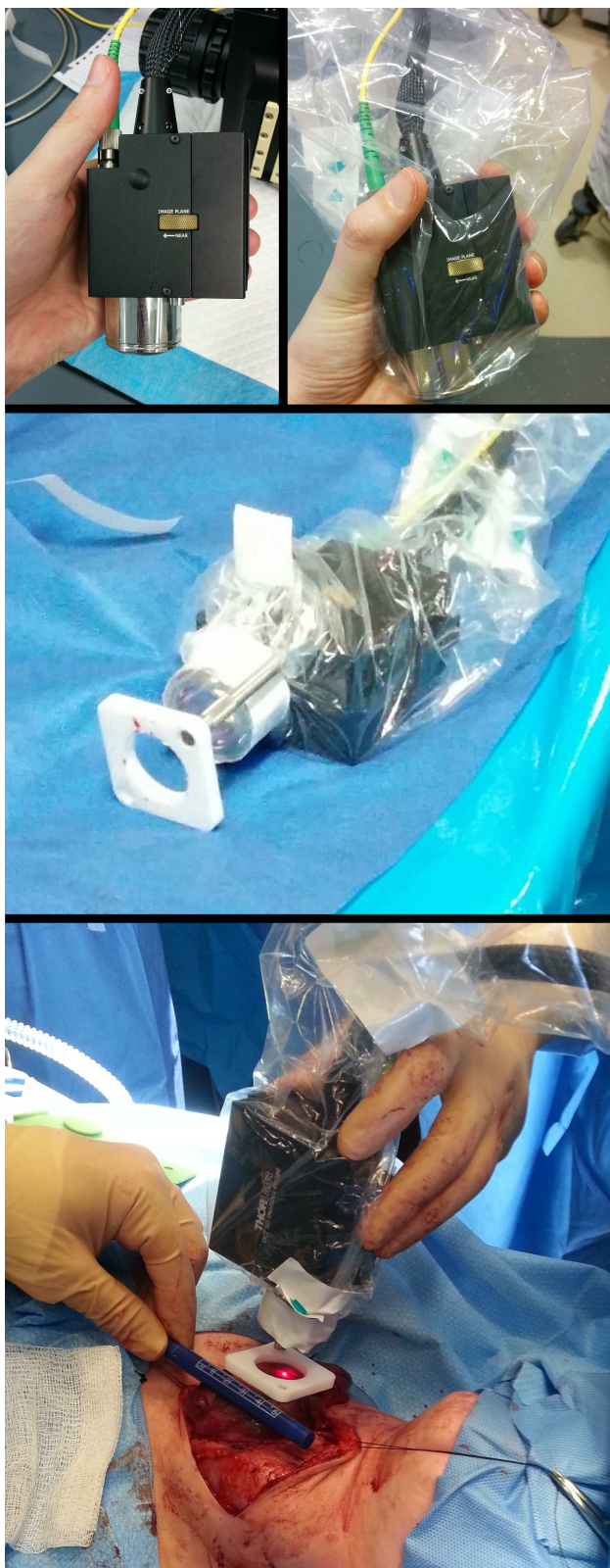
Figure 7.1 Photographies de la sonde : (a) sonde à main, (b) sonde à main avec sac stérile, (c) sonde à main avec sac stérile et garde, (d) sonde en utilisation en champ opératoire.
