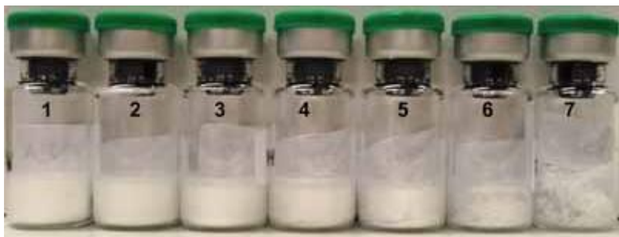
Figure 2.5 Lyophilisats comprenant divers ratios mannitol:sucrose [1) 4:1, 2) 3.5:1.5, 3) 3:2, 4) 1:1, 5) 2:3, 6) 1.5:3.5, 7) 1:4]. Différents degrés d'affaissement ont été observés pour ces formulations [Aucun : 1, Moyen : 2-5, Sévère : 6-7]. Adapté de (Schersch et al., 2009). Copyright 2016, avec la permission d'Elsevier.
