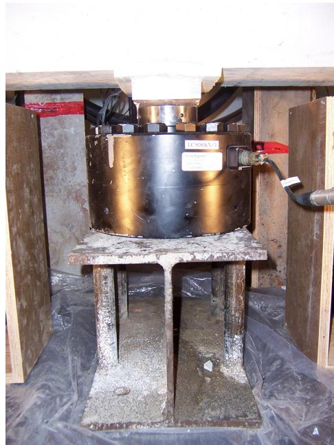
**Figure 4.13 : Système d'appui fixe**
