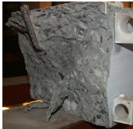
**Figure G.2 : Crochet agissant comme renforcement dans la poutre de BHP50  $\rho = 0 \%$**
