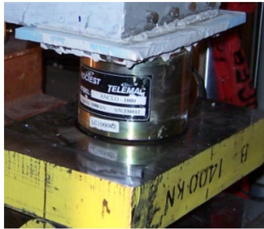
**Figure 4.17 : Cellule de charge 1000 kN**
