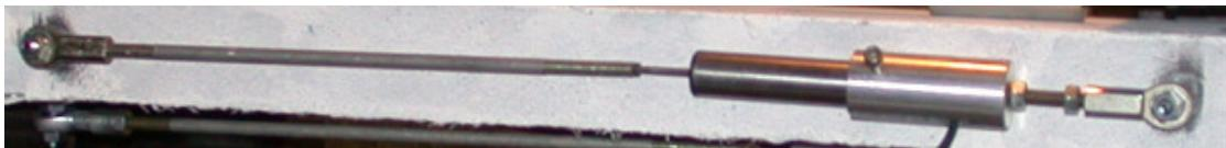
**Figure 3.12 : Rallonge permettant aux LVDT de couvrir de grandes distances**
