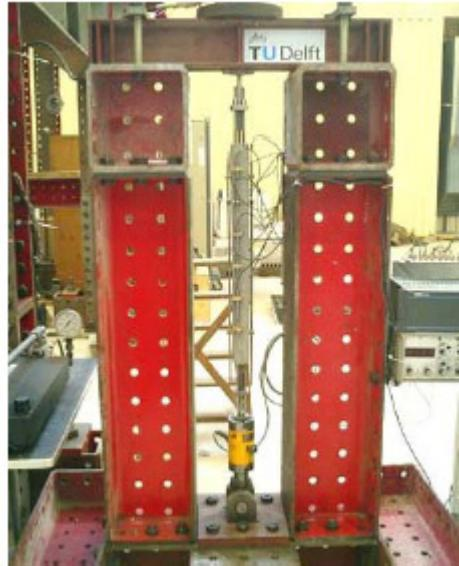
**Figure 2.8 : Essai de traction uniaxiale de Shionaga (2006)**
