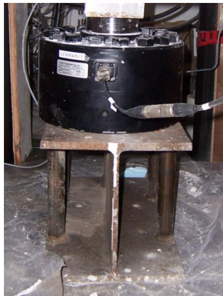
**Figure F.4 : Appui fixe au centre de la poutre**
