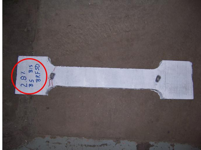
**Figure 3.19 : Fissuration du spécimen de Bischoff BRF50  $\rho = 2,8 \%$**
