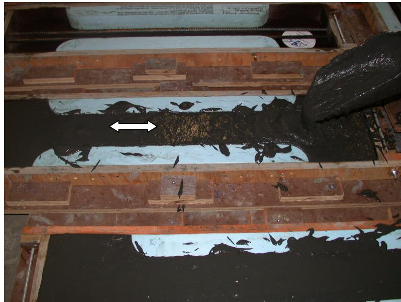
**Figure 3.6 : Sens de la coulée afin de favoriser l'orientation des fibres lors de la coulée du BFUP120 et du BRF50**
