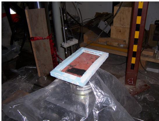
**Figure E.8 : Positionnement du moule de styromousse sur une cellule de charge**
