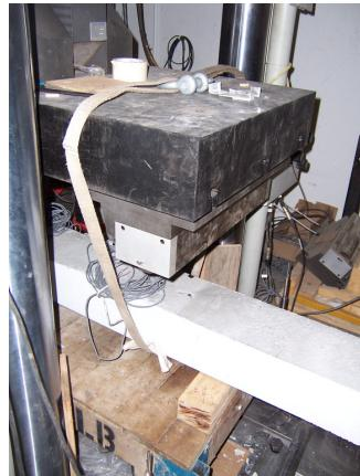
**Figure F.10 : Utilisation de sangles pour soulever la poutre hyperstatique**
