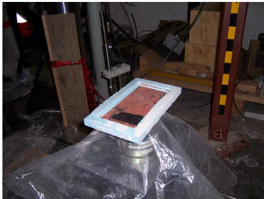
**Figure F.11 : Positionnement du moule de styrémousse sur une cellule de charge**
