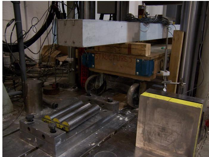
**Figure F.8 : Positionnement de la poutre hyperstatique**
