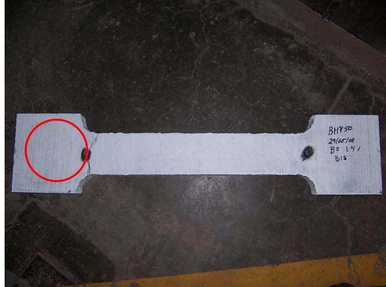
**Figure B.2 :** Fissuration du spécimen de Bischoff BHP50  $\rho = 1,4 \%$
