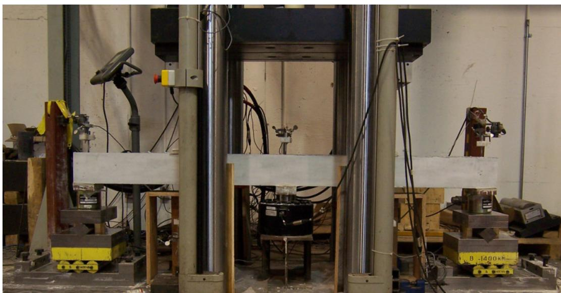
Figure 4.12 : Montage expérimental des essais de flexion hyperstatique
