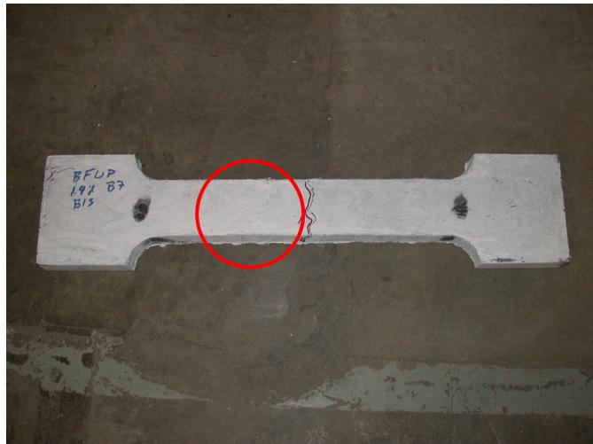
**Figure 3.20 : Fissuration du spécimen de Bischoff BFUP120  $\rho = 1,4 \%$**
