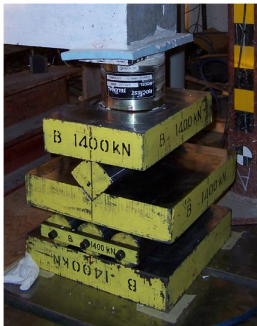
**Figure 4.10 :** Système d'appui à rouleaux
