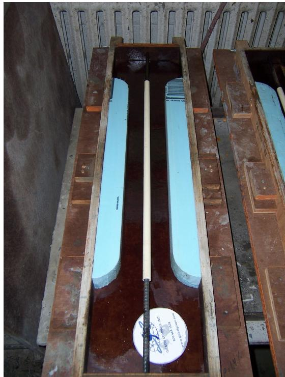
**Figure 3.5 : Coffrage d'un spécimen « Bischoff »**
