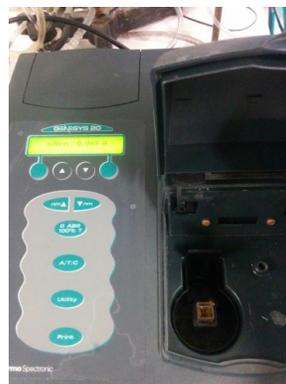
(b) Évaluation de la densité par spectrophotomètre à  $600 \mu m$
