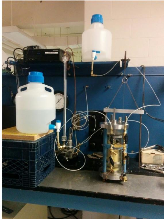
Figure 3.11 Saturation de l'échantillon par écoulement
