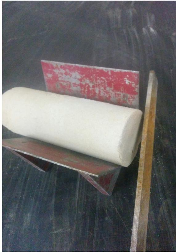
Figure 3.10 Taillage des échantillons
