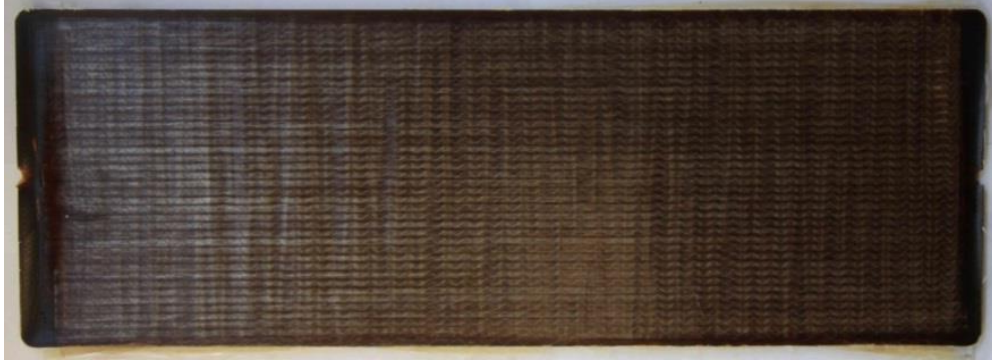
Figure 2-4 : Pièce fabriquée avec les paramètres de fabrication ( P_c = 600 kPa, P_v = -95 kPa et V_f = 58 %) ayant un bel aspect.
