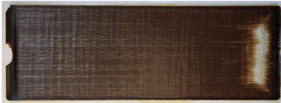
Figure 2-5 : Pièce fabriquée avec les paramètres de fabrication ( P_c = 600 kPa, P_v = 0 kPa et V_f = 62 %) ayant la plus grande zone sèche observée dans ce plan d'expériences.
