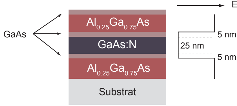
Figure 3.4 Schéma de l'échantillon étudié. Un puits quantique est créé par la présence de deux couches de \text{Al}_{0.25}\text{Ga}_{0.75}\text{As} . La couche d'intérêt de \text{GaAs:N} a une largeur de 25 nm et est comprise entre deux couches tampon de \text{GaAs} de 5 nm d'épaisseur.
