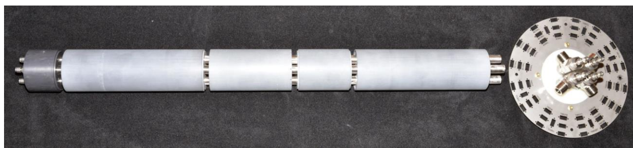
Figure 2-2 : Puits géothermique assemblé partiellement
