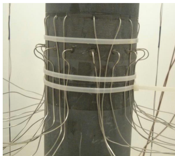
Figure 2-19 : Photo des thermocouples extérieurs du plan de mesure radial
