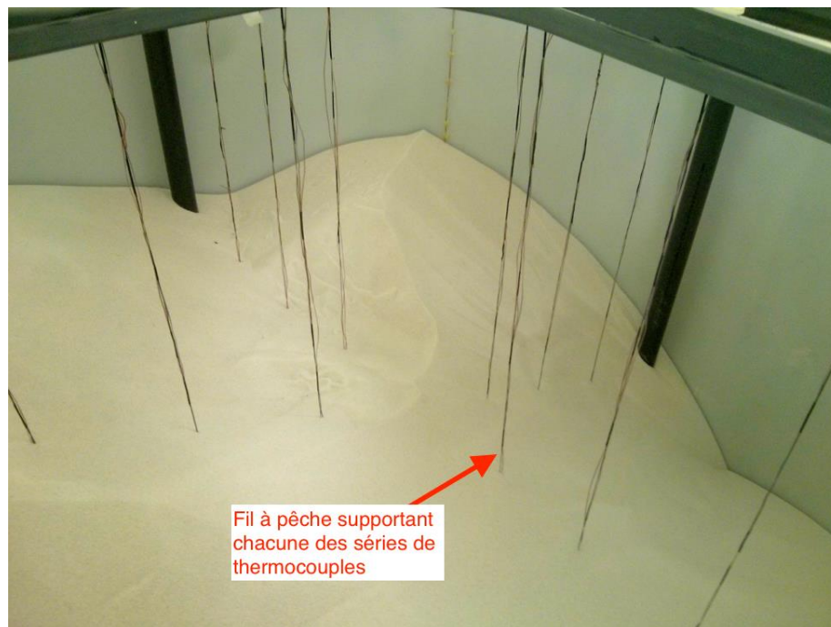
Figure 2-23 : Vue des thermocouples intérieurs du bac à sable
