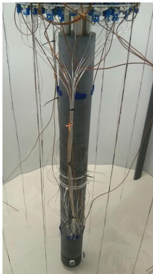
Figure 2-4 : Puits assemblé et instrumenté; Vue de côté 2
