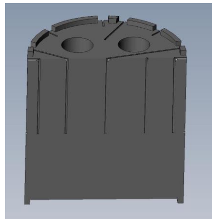
Figure 2-18 : Vue en coupe de la pièce de céramique contenant le plan de mesure radial
