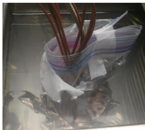
Figure A-3 : Cylindre de cuivre contenu dans un sac de plastique et immergé dans le bain.
