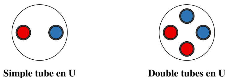
Figure 1.3 : Différents types de puits géothermiques verticaux en boucle fermée
