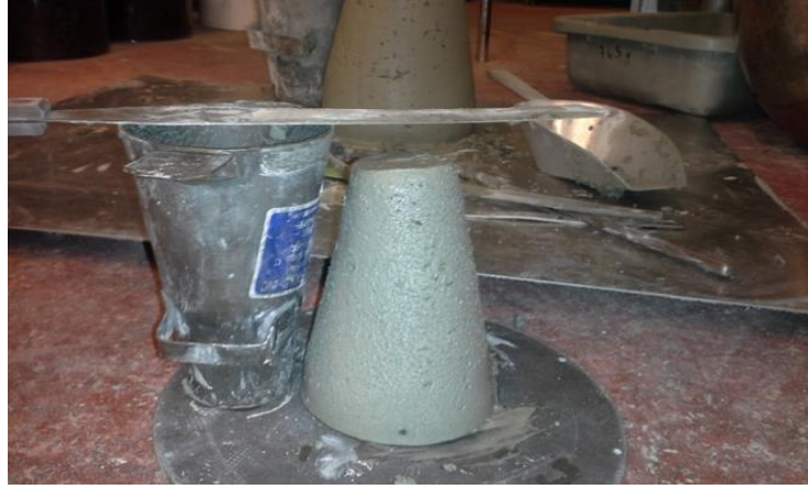
Figure 2.5 : Essai d'affaissement au petit cône d'Abrams
