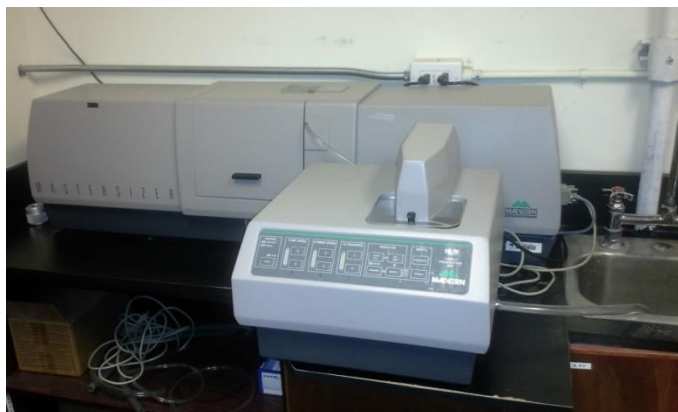
Figure 3.2 : Granulomètre à diffraction laser Mastersize 2000 utilisé
