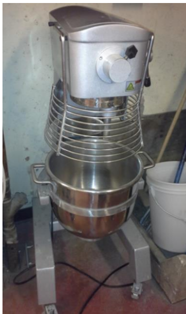
Figure 3.5 : Malaxeur Hobart utilisé dans la préparation de recettes du remblai en pâte (Laboratoire URSTM).
