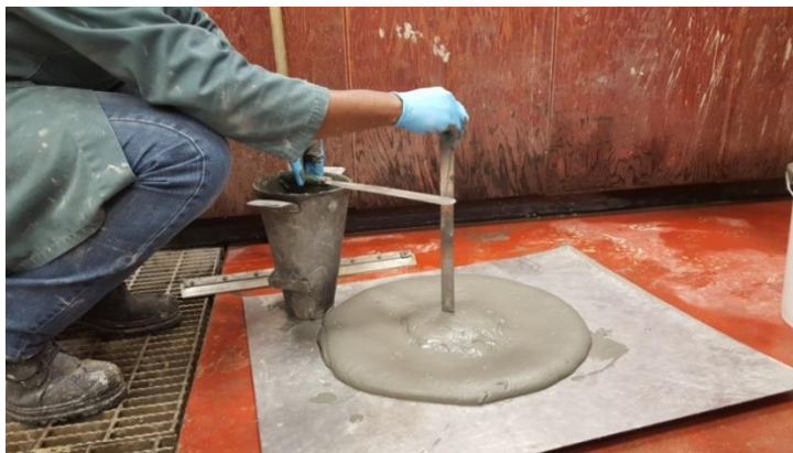
Figure 3.18 : Essai d'affaissement au cône d'Abrams du remblai en pâte lors du mini essai d'écoulement en boucle.
