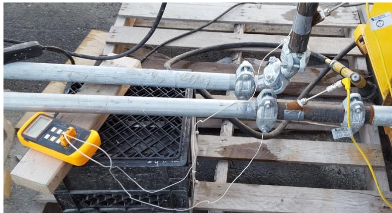
Figure 3.16 : Thermocouples de type K fixés sur la paroi de la conduite en acier et connectés au thermomètre numérique 6802 II
