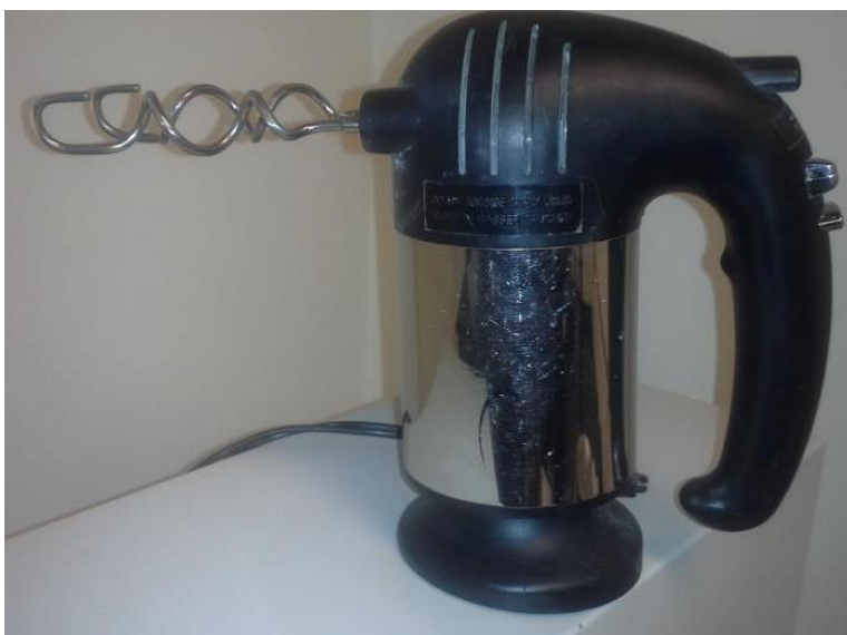
Figure 3.6 : Malaxeur manuel utilisé pour les mélanges d'essais rhéologiques.
