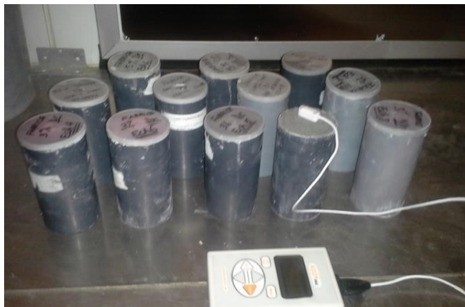
Figure 3.11 : Mesure des propriétés thermiques du remblai en pâte à l'aide du capteur SH-1 de l'analyseur thermique KD2 Pro
