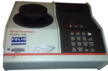
Figure 3.4 : Pycnomètre à hélium AccuPyc 1330 de Micromeritics
