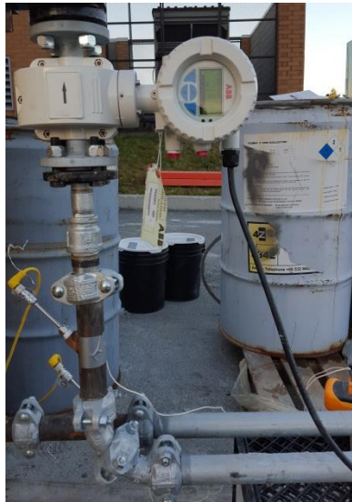
Figure 3.17 : Débitmètre électromagnétique de type « Process Master FEP315 » monté sur le circuit d'essai de pompage.
