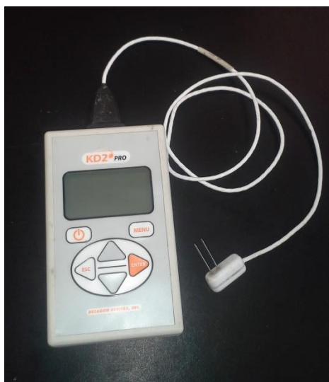
Figure 3.10 : Analyseur thermique KD2 Pro et le capteur SH-1
