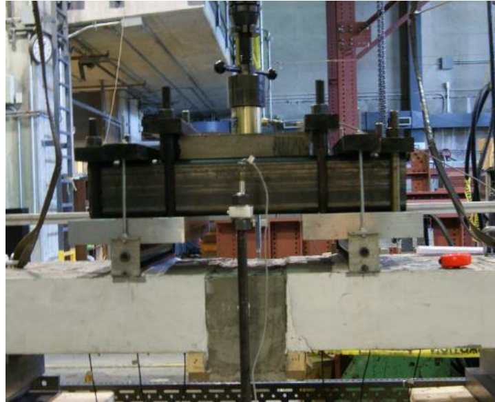
Figure 5-28 : Photo de l'application de la charge pour le moment positif
