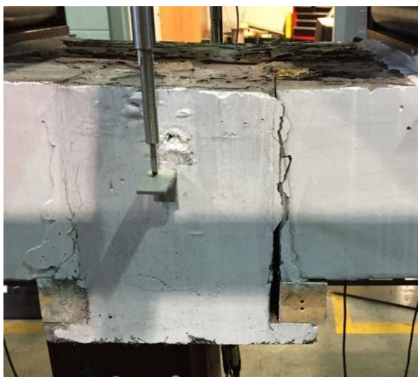
Figure 5-31 : Détérioration du spécimen avec barres interrompues suite au chargement cyclique (S5-P)
