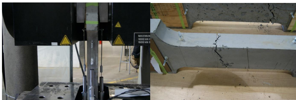
Figure 5-4 : Montage sur la presse de 2500 kN (gauche) et fissuration d'un os en BFHP (droite)
