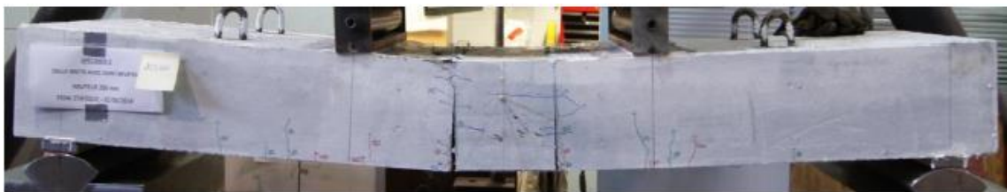
Figure 2-14 : Fissuration du spécimen de Léa Faggio (Faggio, 2014)
