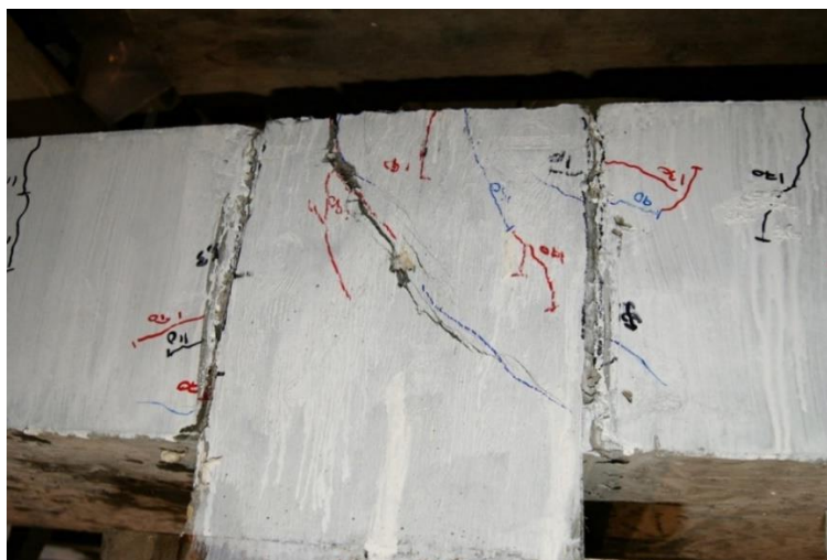
Figure 5-23 : Patron de fissuration du spécimen avec joint droit à la rupture – S1-D
