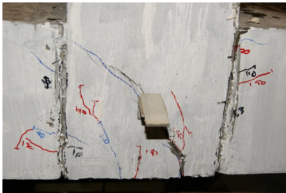
Figure J-1 : Fissuration au niveau du joint du spécimen avec un joint droit (S1-D)
