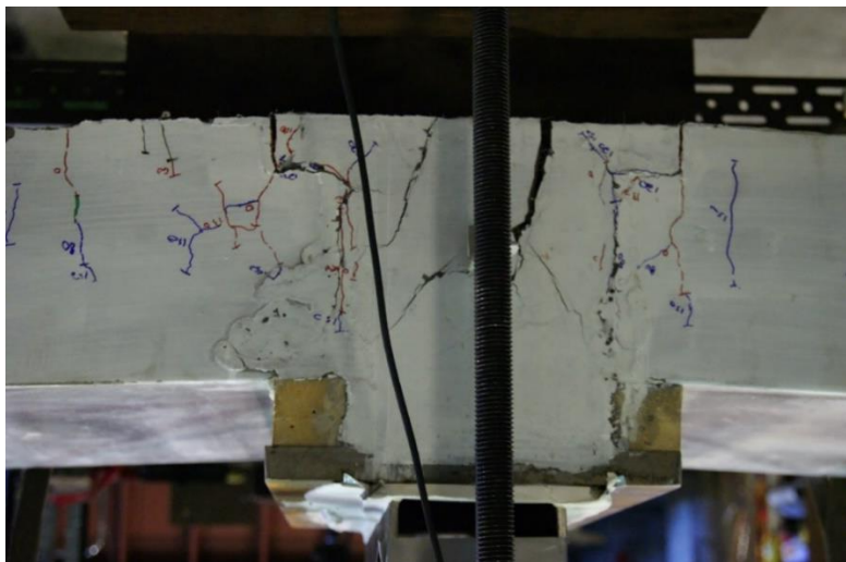
Figure 5-24 : Patron de fissuration du spécimen avec les petites ailes à la rupture – S2-PA
