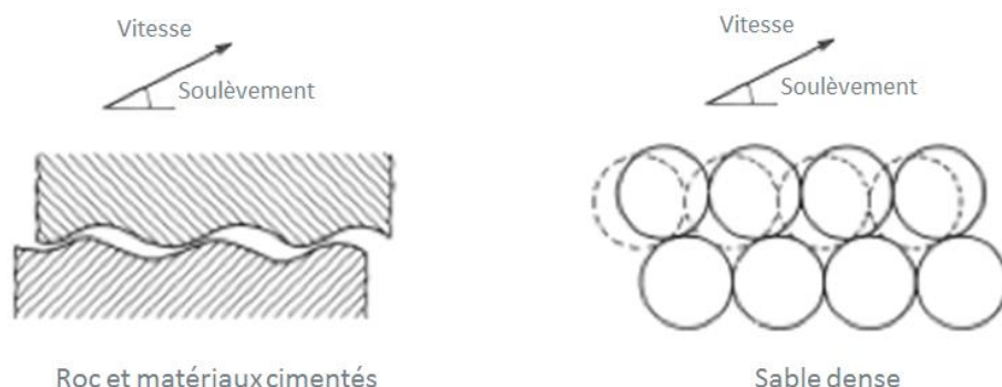
Figure 3.7 : Phénomène de dilatance dans le roc, les matériaux cimentés et le sable dense (tirée de Vermeer et de Borst (1984)).
