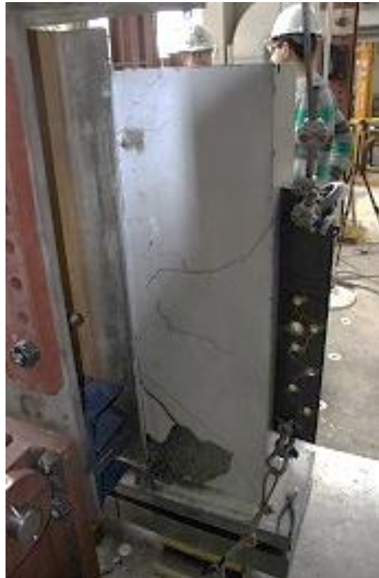
Figure 4-12: Mode de rupture du spécimen O8-G0-Ax
