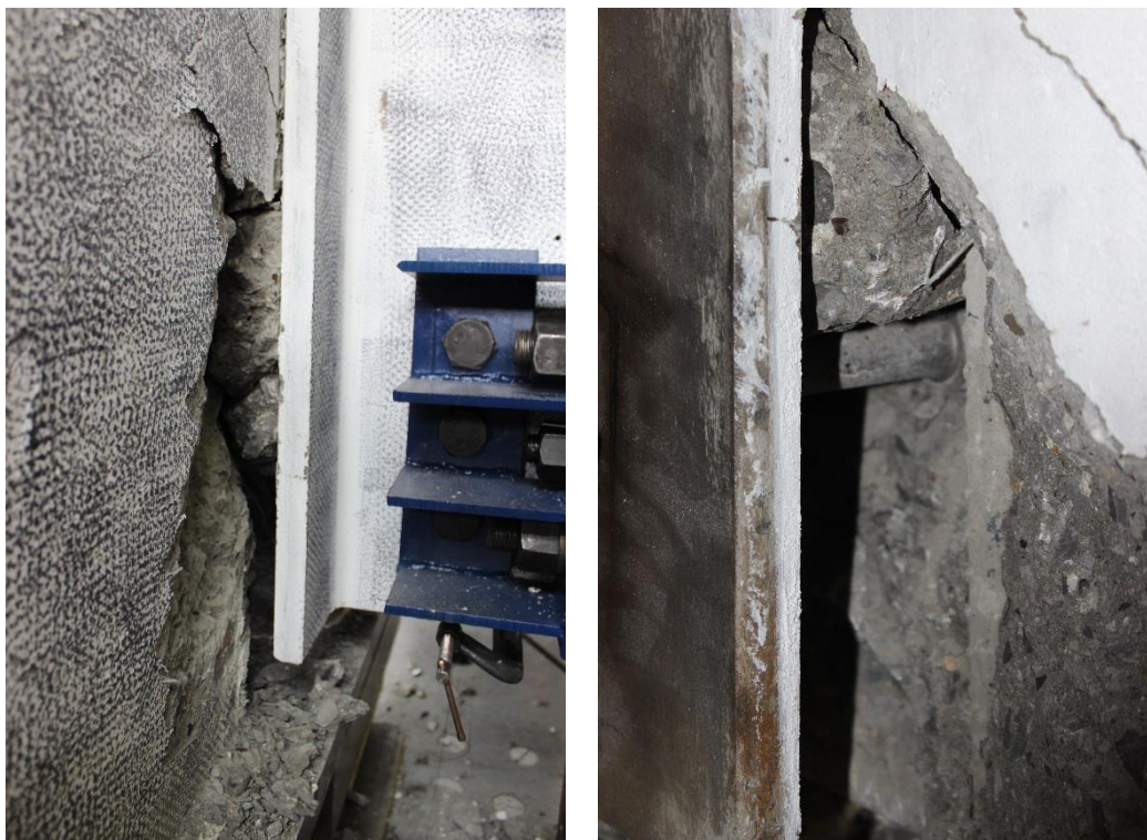
Figure 4-13: Détail du mode de rupture du spécimen O8-G0-Ax
