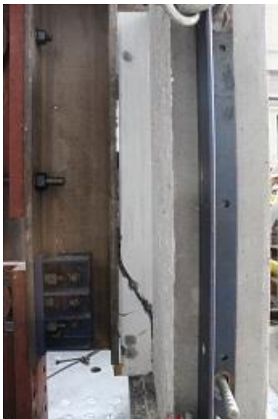
Figure 4-16: Mode de rupture du spécimen F8-G100-DU
