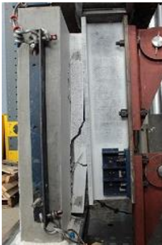
Figure 4-14: Mode de rupture du spécimen F16-G75-Cx
