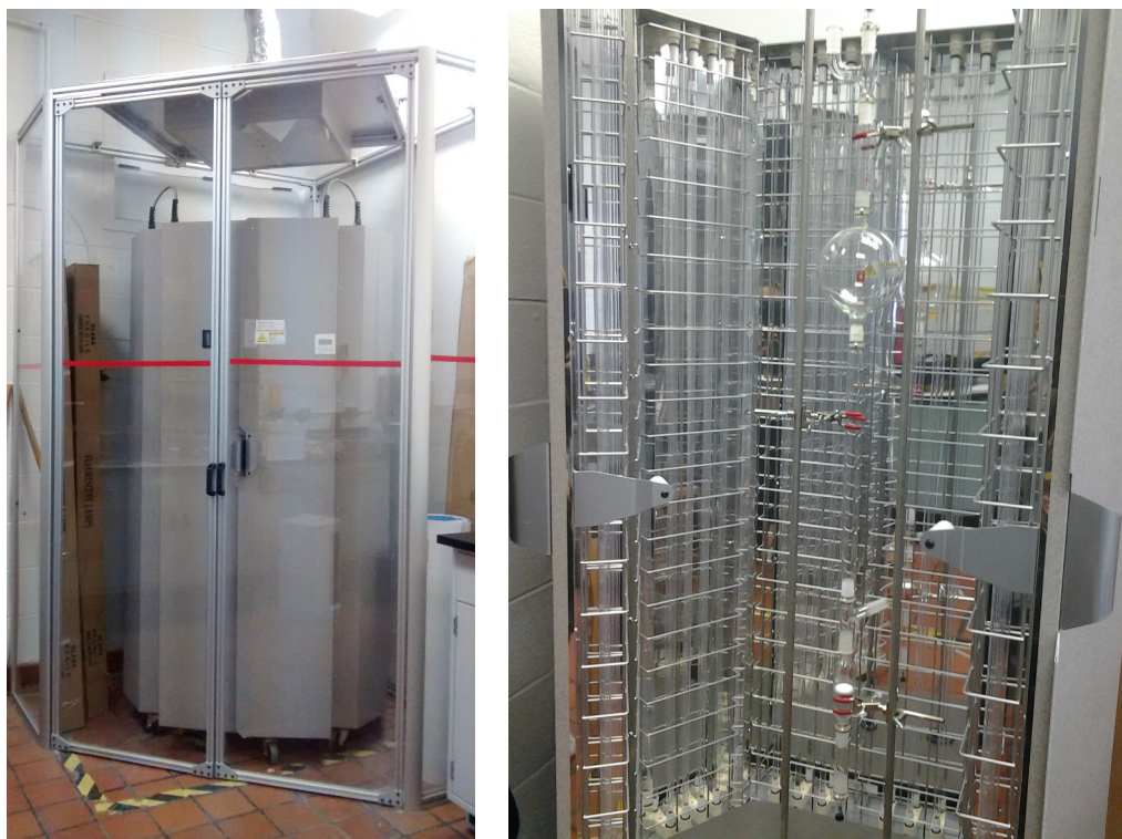
Figure 5-2 : Lit fluidisé pour le dépôt chimique photo-initié en phase vapeur (tiré de Farhanian, 2014) 143
