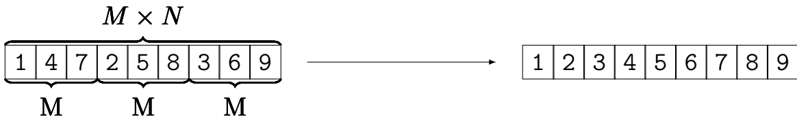
Figure 4.6 Optimisation de la lecture par pointeur d'un vecteur de longueur M \times N - Les numéros représentent l'ordre de lecture avant et après optimisation
