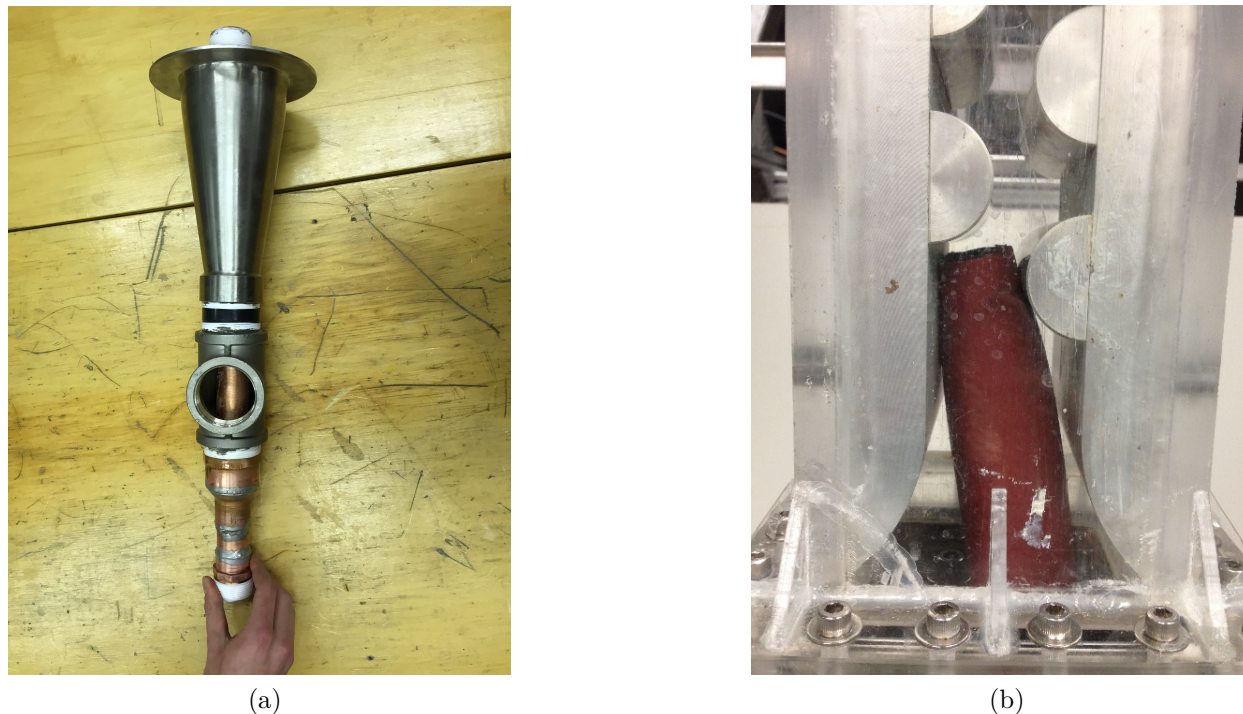
Figure 3.5 Photos de l'injection permettant un meilleur mélange.
