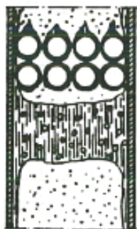
Figure 7.4 : Schéma de la configuration intermittente de Grant et Chisholm (citée par Ulbrich et Mewes)
