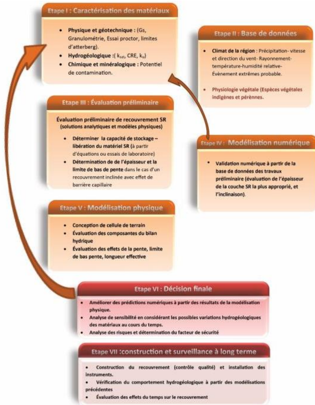
Figure H.1 : Les différentes étapes de la conception d'une couverture store-and-release inclinée
