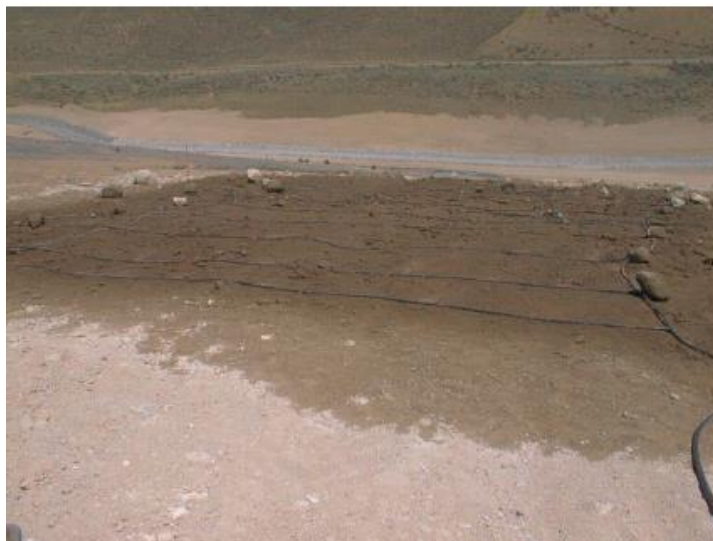
Figure 2.10 : Simulation d'un essai d'irrigation/infiltration sur la mine Goldstrike (Zhan et al. 2014)
