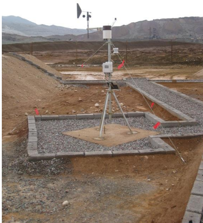
Figure 3.20 : Station météorologique installée au site Kettara
