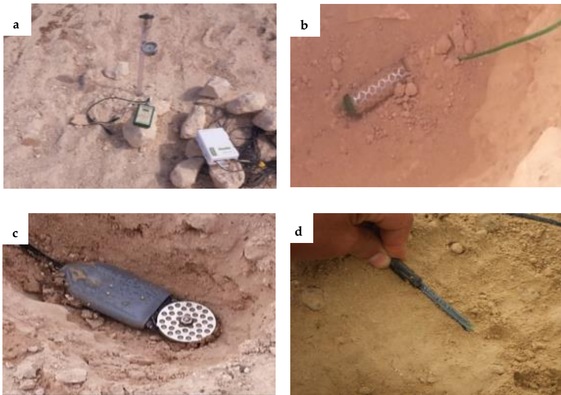
Figure 3.19 : Instrumentation utilisée dans la cellule inclinée; a) Tensiomètre Jetfill et système d'acquisition Em 50; b) bloc Watermark; c) sonde EC 5; d) capteur MPS-2
