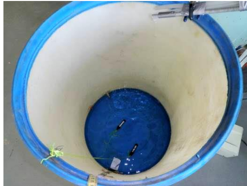
Figure 4.14 : Placement d'une sonde à pression dans le baril d'exfiltration en incluant une couverture d'eau.
