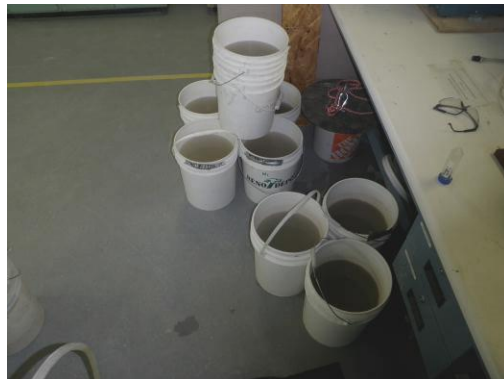
Figure 4.17 : Décantation des sédiments provenant de l'exfiltration dans les chaudières
