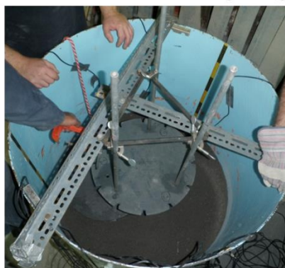
c) Ajustement de l’instrument de guidage sur la cuve
