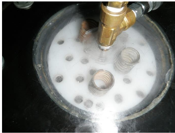
Figure D.5 : Placement des ressorts entre la plaque perforée et le couvercle afin de garder le matériau en place
