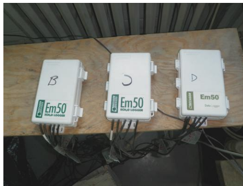
Figure 4.12 : Boîtiers d'enregistrement des données des sondes diélectriques (Decagon Em50).
