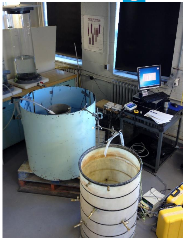
Figure 4.11 : Équipements utilisés pour les essais d'infiltration à charge constante dans la cuve. Schéma et photo.
