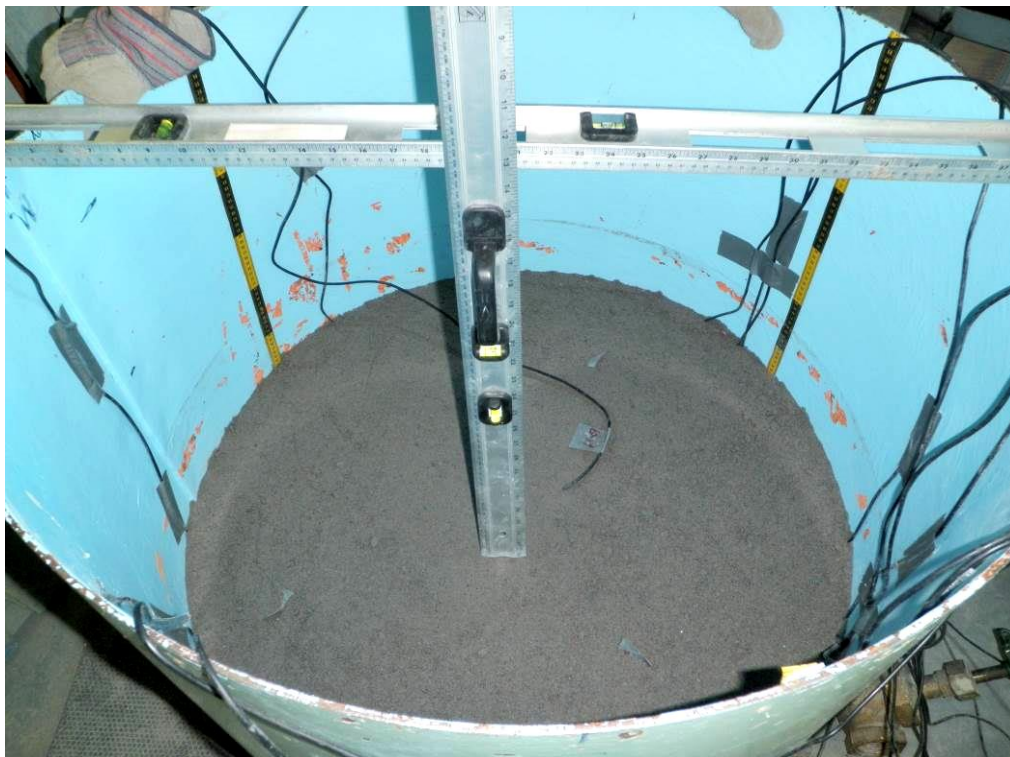
Figure 4.8 : Photo qui montre la méthode pour mesurer la hauteur du matériau dans la cuve
