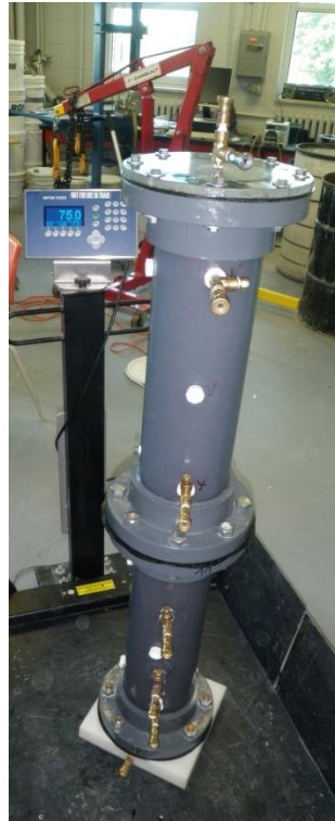
Figure D.6 : Prise de la masse de la colonne contenant du matériau et qui est saturée à l'eau distillée et désaérée.
