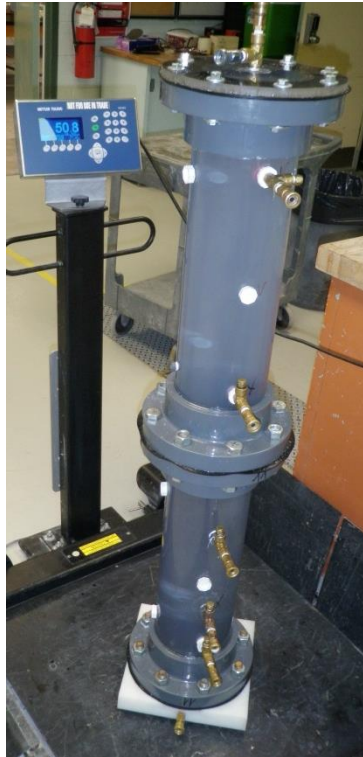
Figure D.2 : Colonne remplie d'eau distillée désaérée
