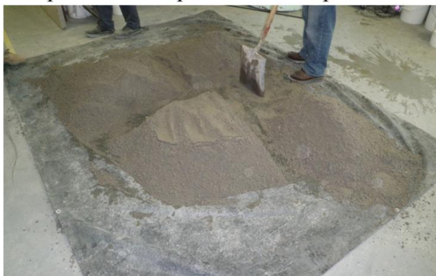
Figure 4.3 : Quartage et homogénéisation des roches stériles selon la procédure ASTM C702-Méthode B.
