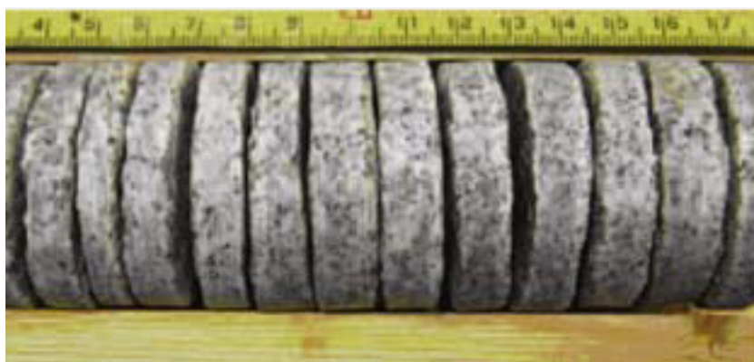
Figure 2.25 : Core diskings sur le granite du Lac Bonnet (tiré de Lim et Martin, 2010)
