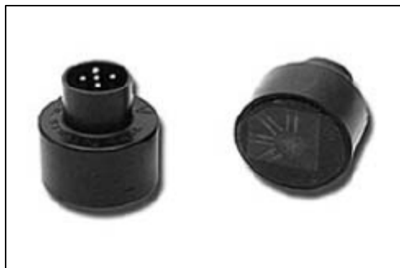
Figure 2.18 : Cellule du doorstopper conventionnel (tiré de Leite et al., 2010)
