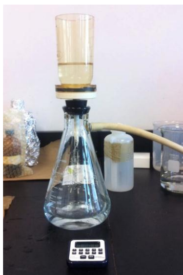
Figure 4.4 : Assemblage de l'équipement de filtration pour les essais de filtrabilité
