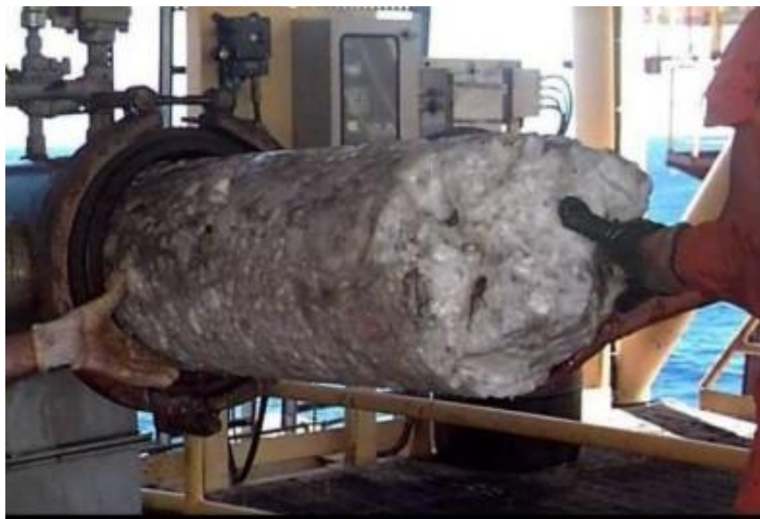
Figure 1. 2 : Bouchon d'hydrates de gaz dans un oléoduc (Heriot Watt Institute of Petroleum Engineering, 2015)
