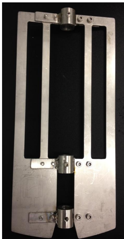
Figure 2. 9 : Photographie du mélangeur Maxblend utilisé dans les expériences
