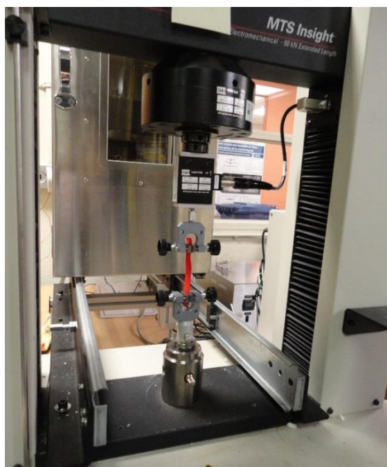
Figure 8-1 : Photographie de l'éprouvette dans la machine d'essai.
