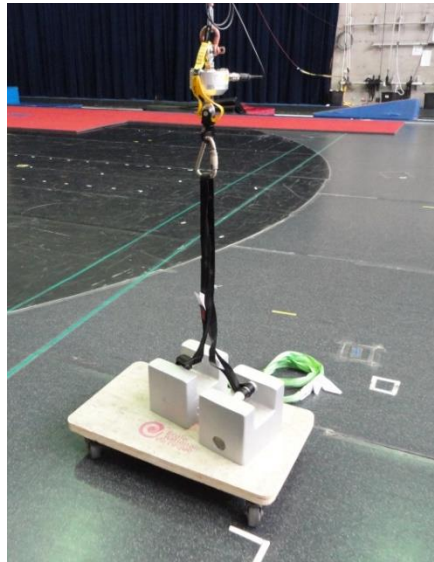
Figure 4-4 : Photographie du banc d'essai et des deux poids de calibration.
