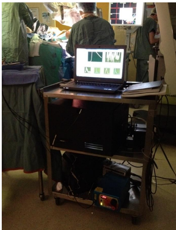
Figure 3.6 : Montage expérimental transporté et utilisé en salle d'opération. Il s'agit du même chariot que celui présenté à la Figure 2.2 (spectroscopie Raman seulement), mais le système de spectroscopie par fluorescence et réflectance est maintenant ajouté et placé dans la boîte noire de transport visible ici sur la deuxième tablette.
