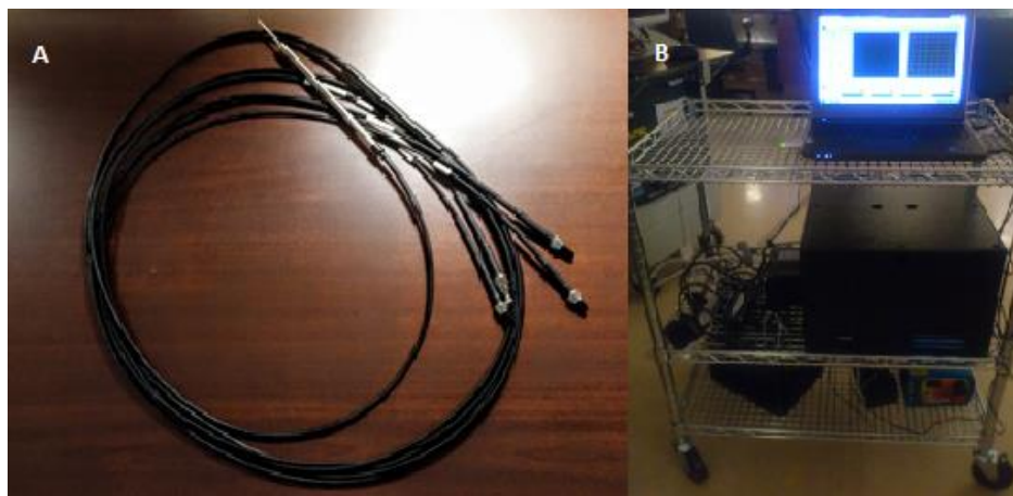
Figure 3.7 : Nouveau système amélioré en termes de robustesse pour la salle d'opération. A. La sonde est maintenant munie d'une gaine métallique résistante qui empêche toute déformation des fibres optiques à l'intérieur du câble et B. le nouveau chariot de transport est plus robuste, et l'augmentation de sa dimension totale laisse un espace de travail libre, et permet même l'ajout d'instruments supplémentaires dans le futur.
