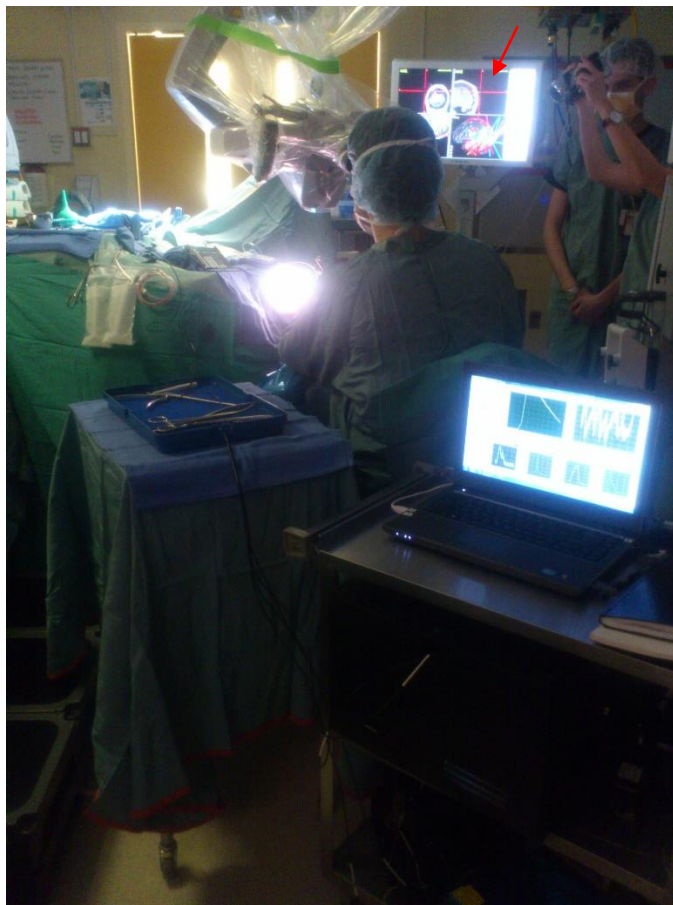
Figure 4.1 : Installation du système en salle d'opération durant la chirurgie. Le chariot est en retrait de la zone stérile, tandis que la sonde y est placée afin d'être manipulée aisément par le chirurgien. L'écran situé au fond sur l'image permet de localiser le bout de la sonde (où est faite l'acquisition) avec les images RM préopératoires et la neuronavigation.
