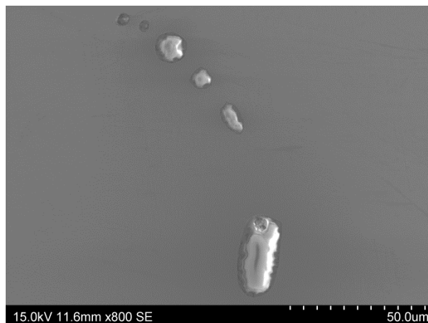
Figure 4-3 : Inclusions observées dans le 0.018% C revenu à 610°C pendant 8h [127].
