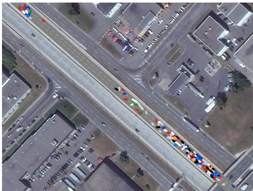
Figure 4-9 : Exemple d'un carambolage causé par un mauvais jeu de valeurs pour les paramètres de modèle de poursuite Wiedemann 99
