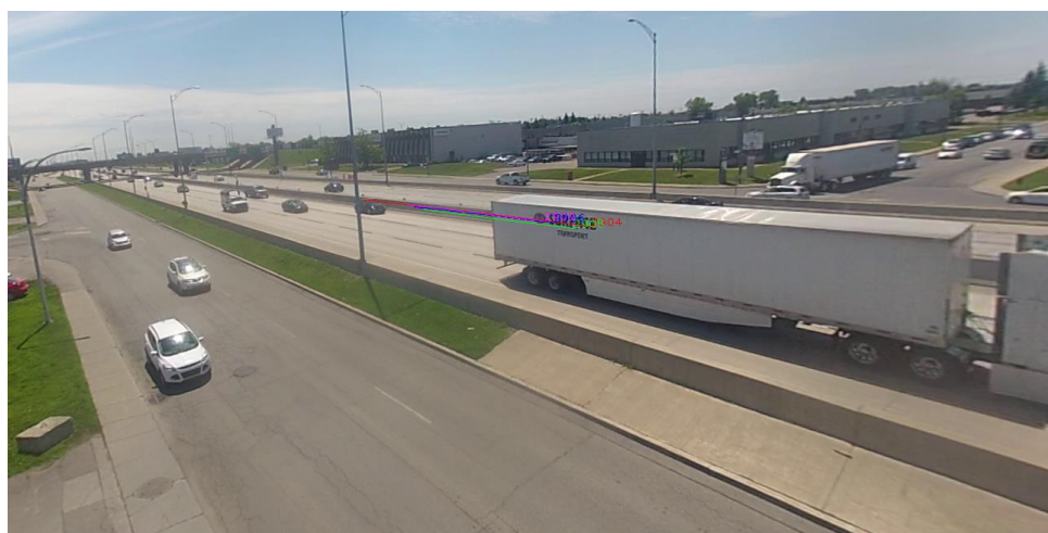
Figure 3-10 : Exemple d'un camion détecté très haut sur la boîte de sa remorque, engendrant une augmentation de l'erreur de parallaxe
