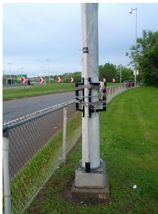
Figure 3-7 : Installation du système de collecte vidéo sur un fût d'éclairage du Ministère des Transports du Québec aux abords de l'Autoroute A20 dans l'Ouest de l'île de Montréal
