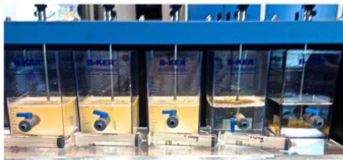
Figure 3-5. Banc d'essai PB-900<sup>TM</sup> Programmable Jartester (Phipps & Bird, USA) utilisé pour les TFB.
