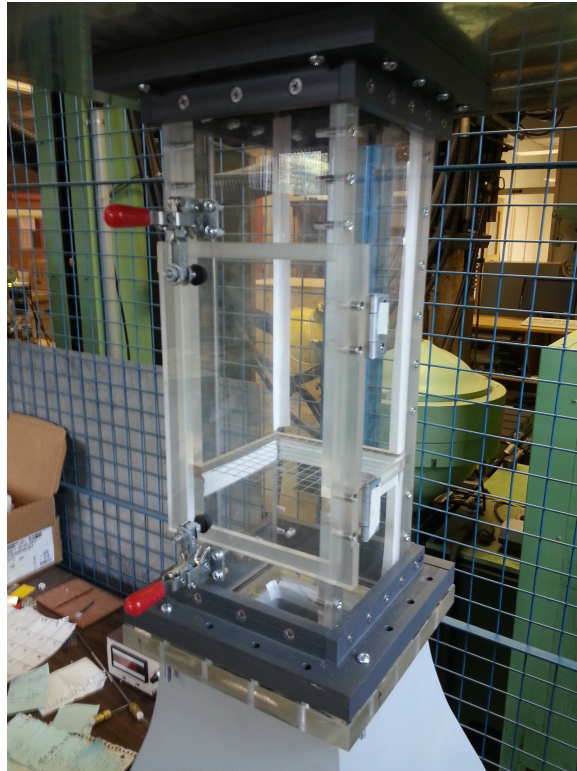
Figure 3.11 Vue agrandie de la section de la soufflerie verticale
