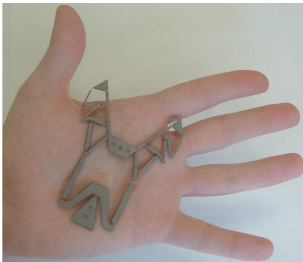
Figure 2.4 Exemple de préhenseur adaptatif utilisant un mécanisme de transmission à membrures rigides et des liaisons compliantes, tirée de Doria et Birglen (2009)
