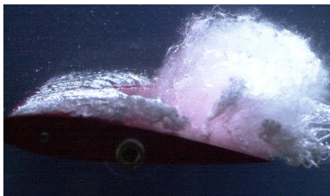
Figure 2-2 La cavitation à poches attachées/nuageuses instationnaires
