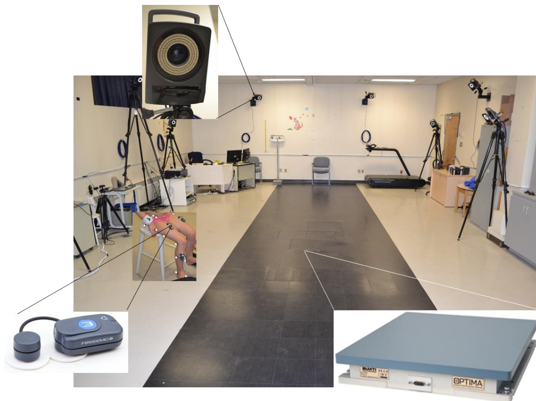
Figure 1 Système de caméras optoélectroniques combinées à des plateformes de force et à un système d'électromyographie.
