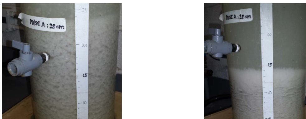
Figure 4-15 : Décantation des boues au fond de la colonne. La photo de gauche est prise après 45 min et celle de droite après 3 heures.
