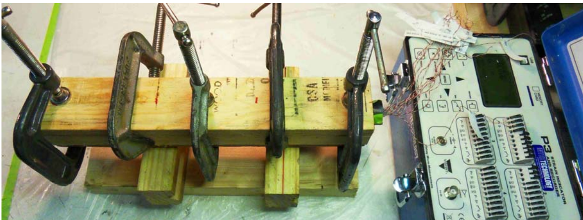
Figure B12 : Mise en place du système de serrage et enregistrement des données
