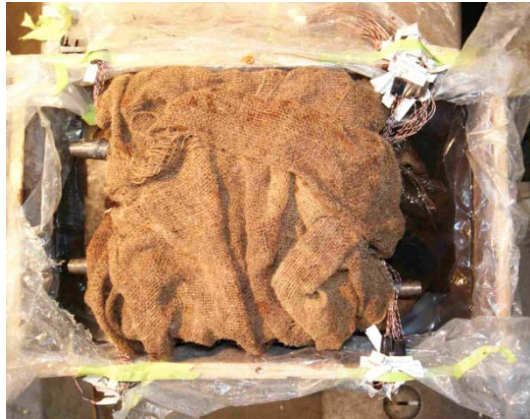
Figure 3.5 : Dispositif de cure humide des spécimens
