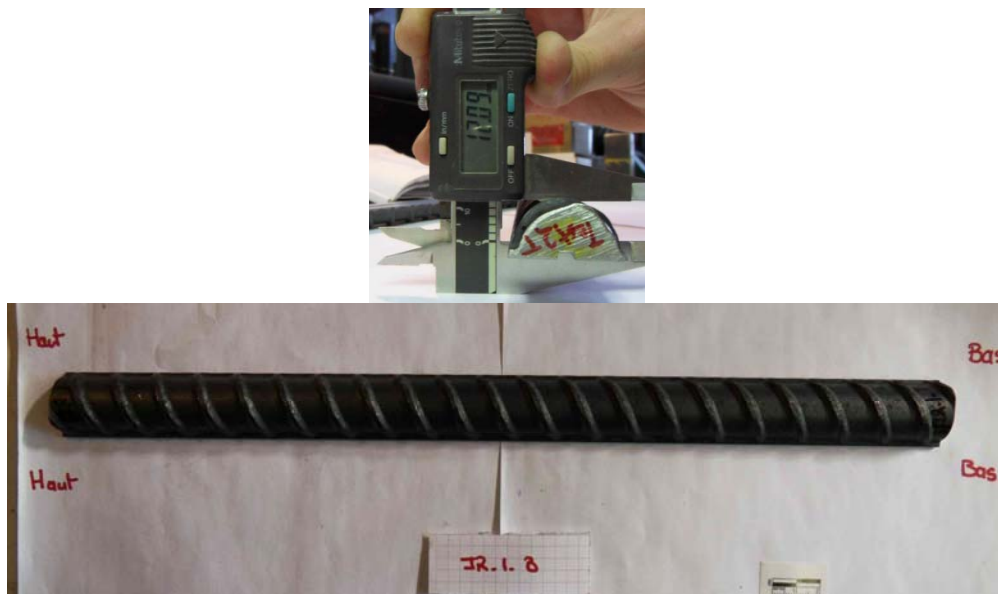
Figure B4 : a) Mesure du demi-diamètre de la barre, b) identification de la barre, Haut, Bas, et si cette demi section correspond à la partie supérieure ou inférieure.
