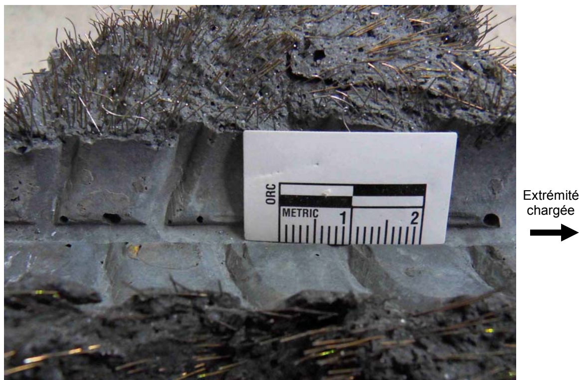
Figure 8.12 : Empreinte des crânelures de l'armature dans le BFUP à la fin de l'essai – Specimen 25-8D-F4
