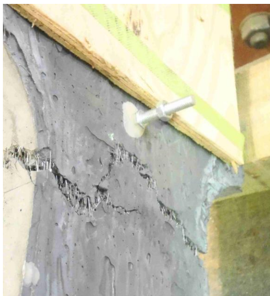
Figure 6.15 : Schéma de fissuration expérimentale suite à la localisation de la fissure (Os #2)
