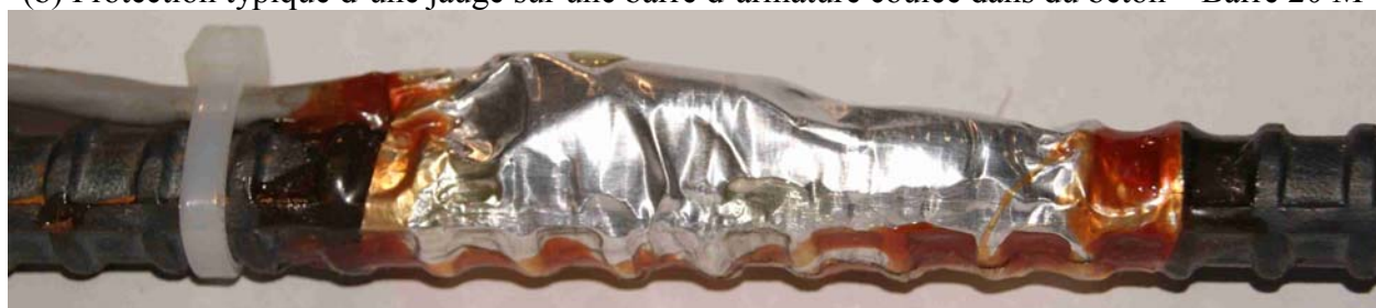
(c) Protection typique d'une jauge sur une barre d'armature coulée dans du béton – Barre 10 M
