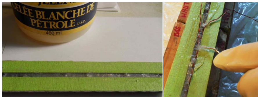
Figure B10 : a) Rainure remplie de gelée de pétrole, b) Repositionnement des fils dans la rainure
