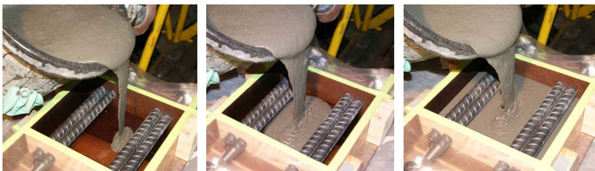
Figure 3.4 : Séquence de coulage à partir du centre du spécimen
