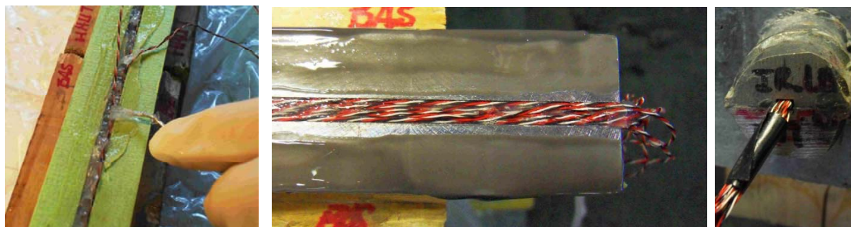
Figure 3.13 : Protection, collage et instrumentation interne finalisés
