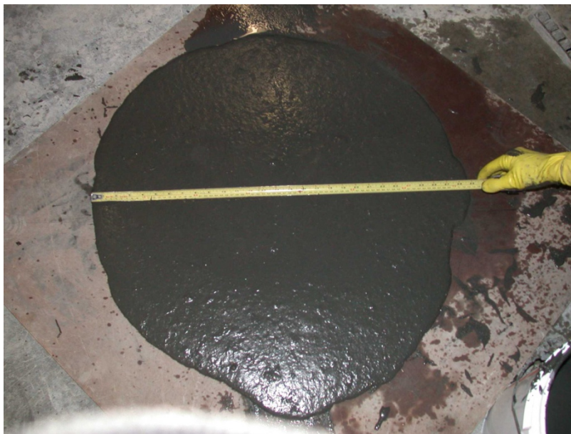
Figure 3.19 : Essai d'étalement BFUP4%
