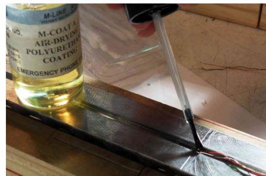
Figure B9 : a) Application du Rosin Solvent, b) Application de la fine protection de polyuréthane (M-Coat-A)
