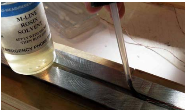
Figure B9 : a) Application du Rosin Solvent, b) Application de la fine protection de polyuréthane (M-Coat-A)
