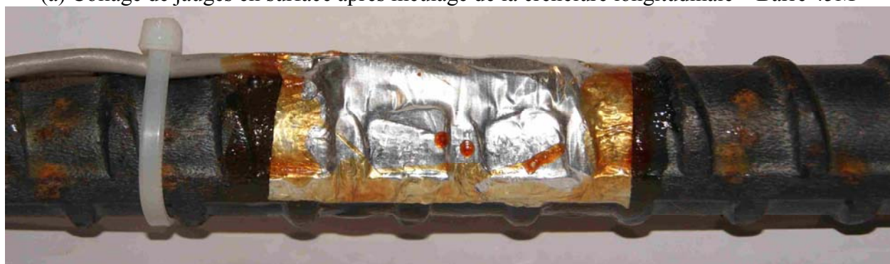
(b) Protection typique d'une jauge sur une barre d'armature coulée dans du béton – Barre 20 M
