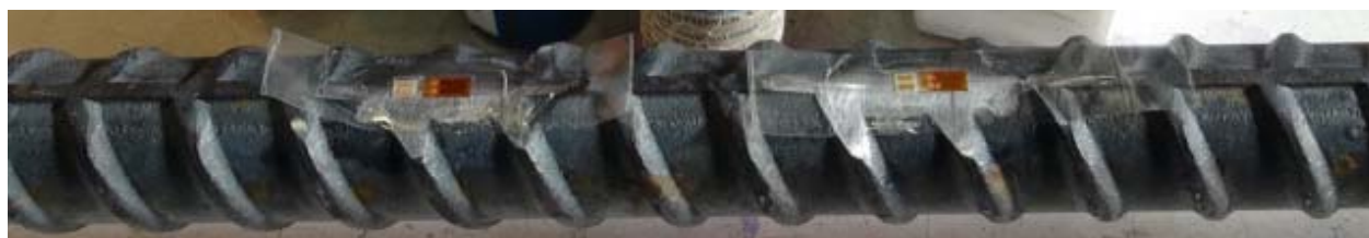
(a) Collage de jauges en surface après meulage de la crénelure longitudinale – Barre 45M
