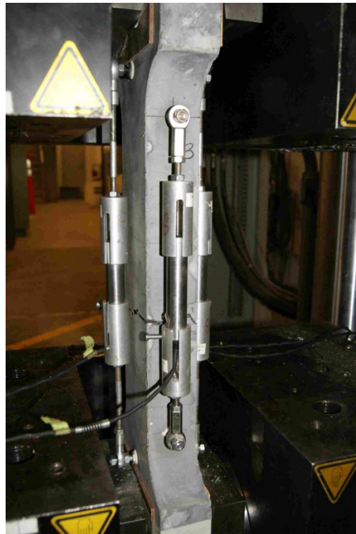
Figure 3.21 : Montage expérimental d'un essai de traction directe
