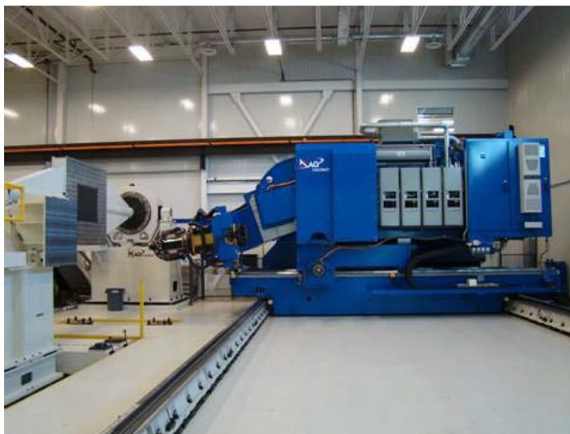
Figure 2.1 Vue d'ensemble d'une machine AFP typique.
