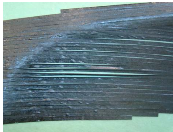
(f) Défaut de type "Bridging"
