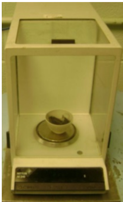
Figure 7.1 Balance électronique de type METTLER AE240 .
