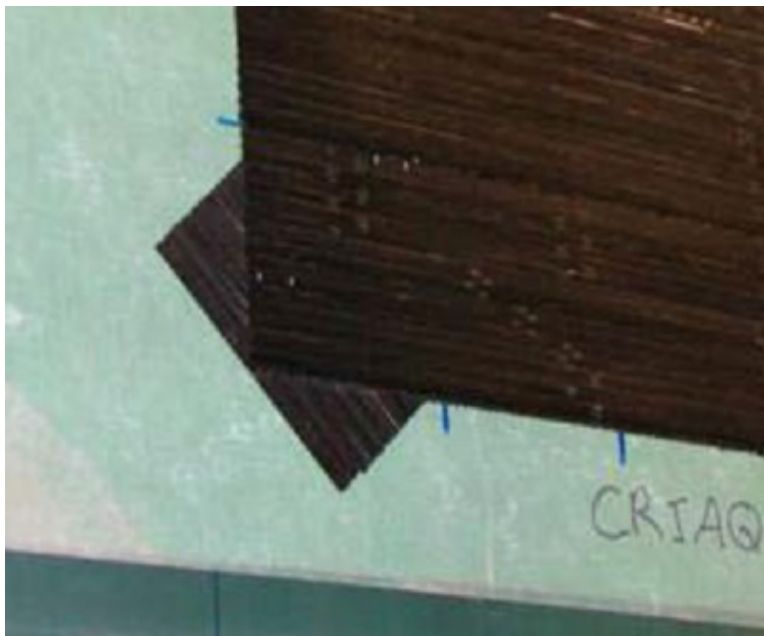
Figure 2.7 Longueur de coupe minimale.
