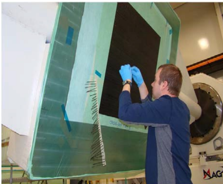
Figure 2.8 Placement à la main de rubans des fibres.
