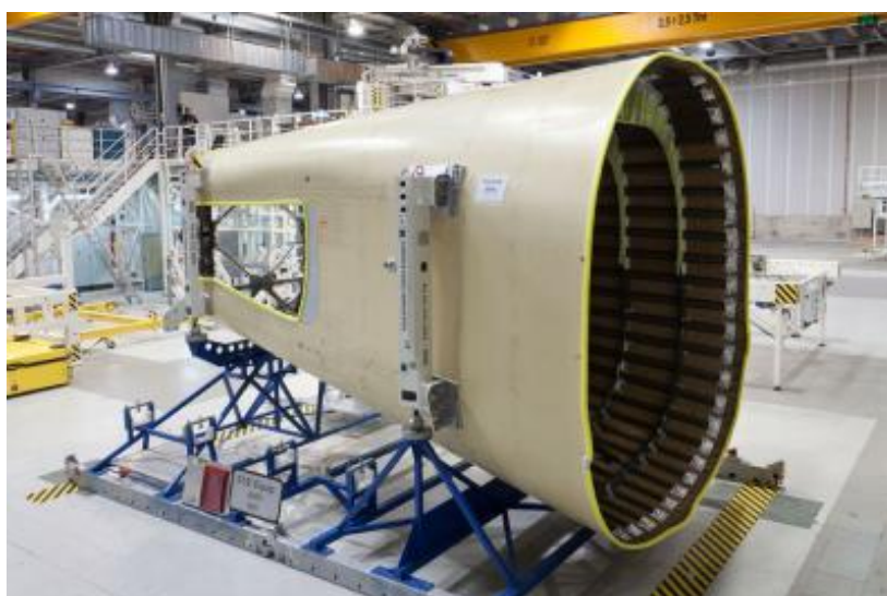
Figure 2.5 La section 19 du fuselage d'Airbus A350 XWB (d'après (Calvo)).
