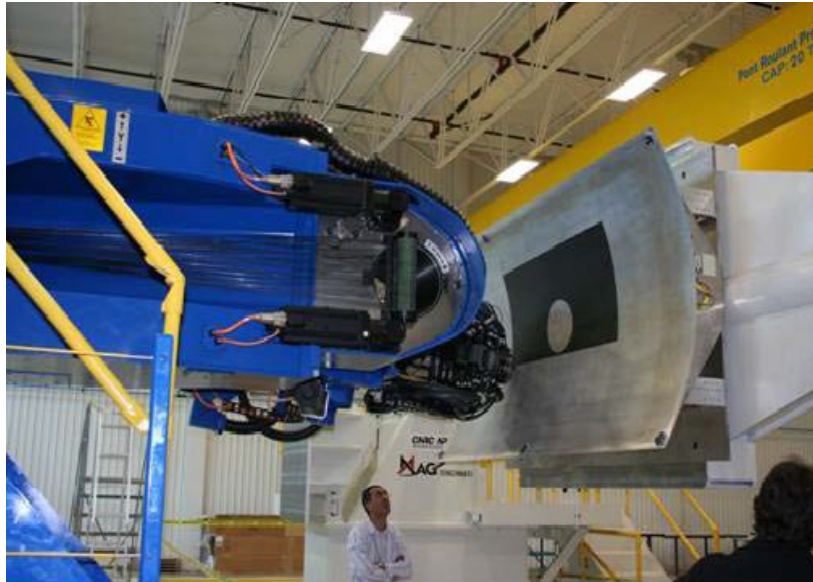
Figure 2.2 Tête robotisée d'une machine AFP.
