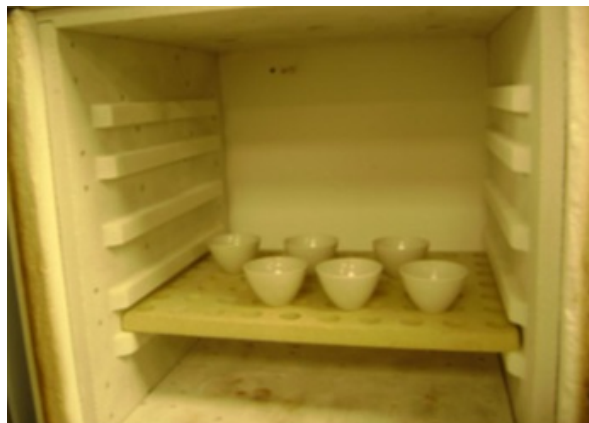
Figure 7.2 Les échantillons dans des creusets en céramique placés au four.
