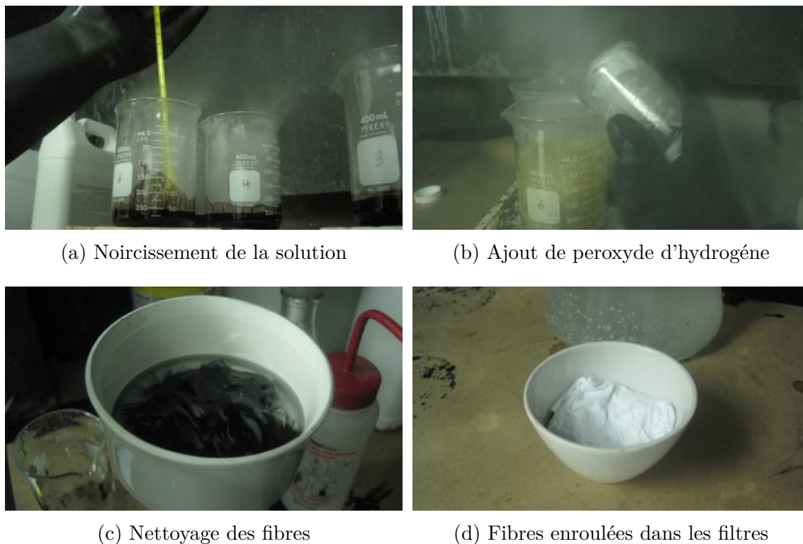
Figure 7.6 Les différents étapes de la procédure de digestion chimique de la matrice.
