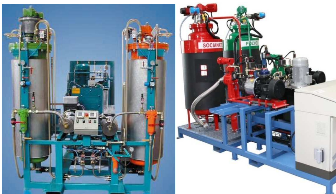
Figure 4.2 : Positionnement en largeur (gauche) et linéaire (droite) des éléments de machines d'injection.
