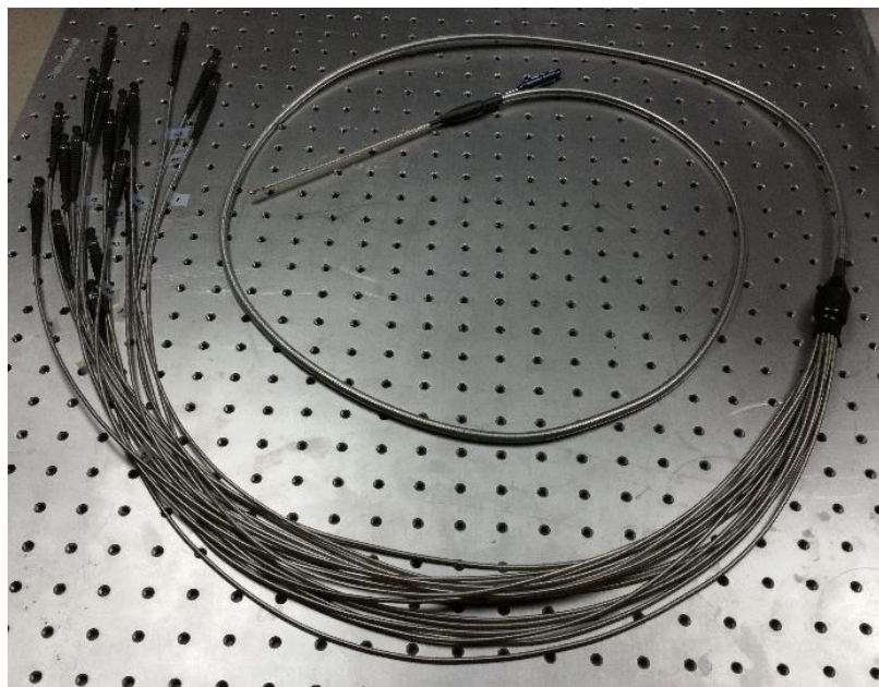
Figure 4-1 : Prototype final avec les 18 fibres intégrées sur l'aiguille, sortant par un tube de 1,62 mètre, se séparant ensuite en 18 petits tubes protecteurs individuels d'environ 85cm de longueur et se terminant chacun par un connecteur SMA.
