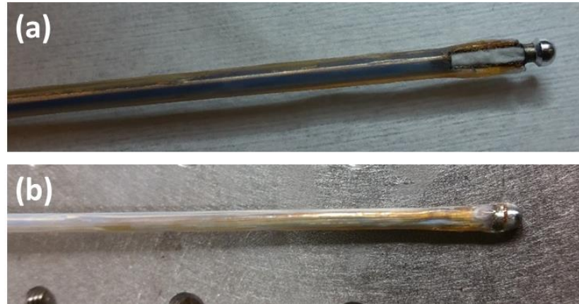
Figure 2-13 : Extrémité de l'aiguille (a) avant et (b) après avoir appliqué la colle optique entre les fibres et le miroir.
