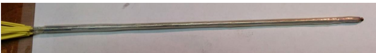
Figure 2-10 : Fibres et tube de métal collés sur l'aiguille de biopsie et recouverts d'une gaine thermorétractable comme protection.
