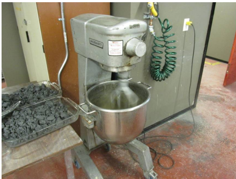
Figure 3-16 : Mixeur Hobart pour la préparation des mélanges de remblai
