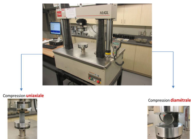
Figure 3-6 : Presse mécanique utilisée pour les essais de résistance à la compression uniaxiale et diamétrale
