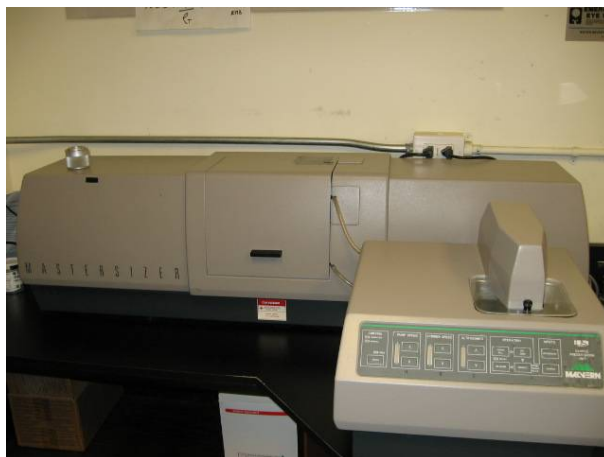
Figure 3-1 : Granulomètre au laser Mastersizer de Malvern
