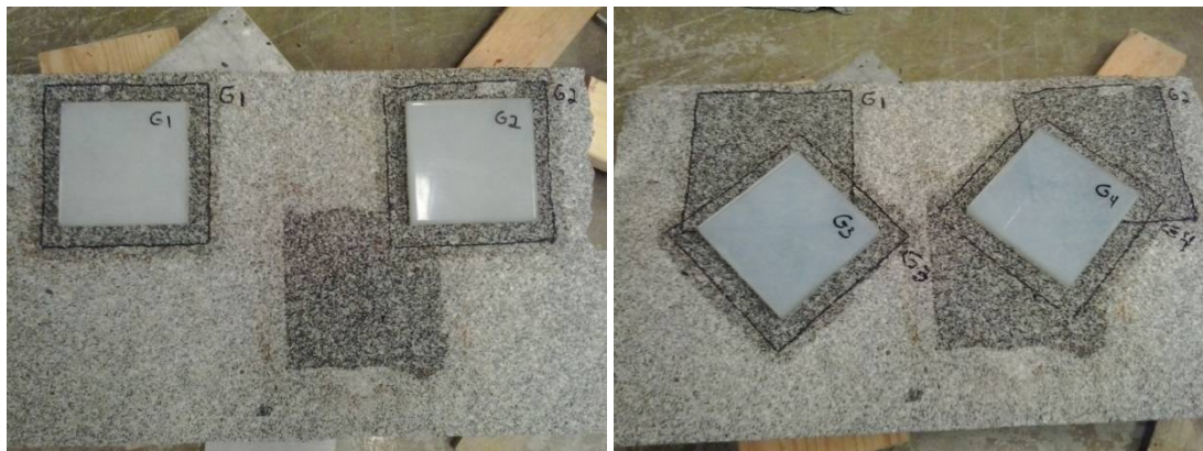
Figure 3-9 : Prise d'empreintes de la surface de granite avec la silicone RTV (G1, G2, G3, G4)
