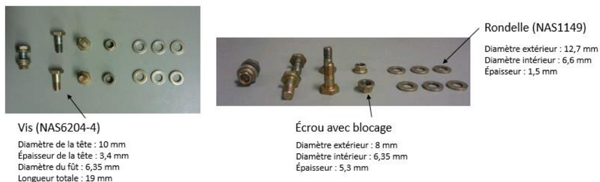
Figure 4-1 : Dimensions de la vis, l'écrou et les rondelles
