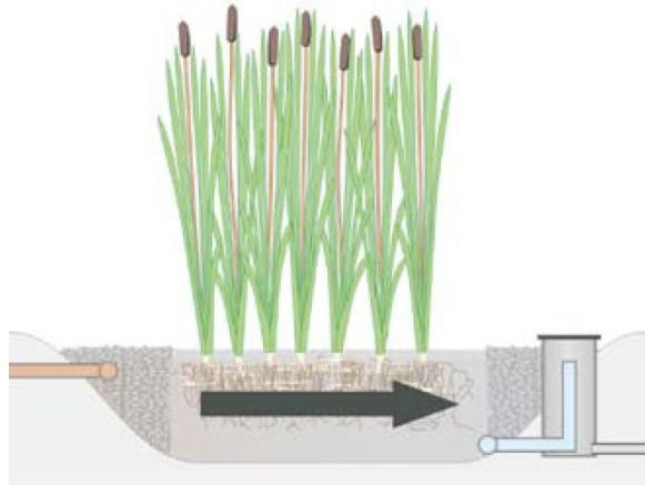
Figure 2-3 : Vue en coupe d'un marais sous-surfaceux à flux horizontal (tiré de Société québécoise de phytotechnologie, 2013)
