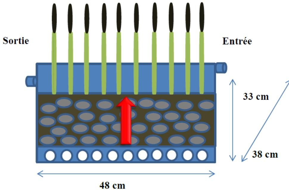
Figure 3-2 : Configuration expérimentale sous-surfacique à écoulement vertical.
