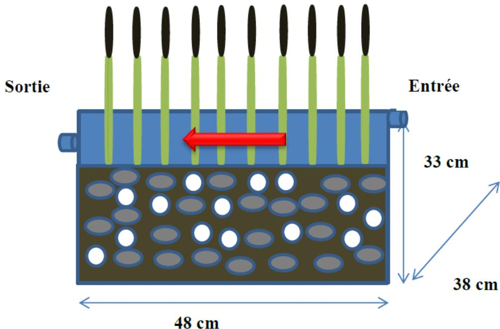
Figure 3-3 : Configuration expérimentale surfacique à écoulement horizontal.
