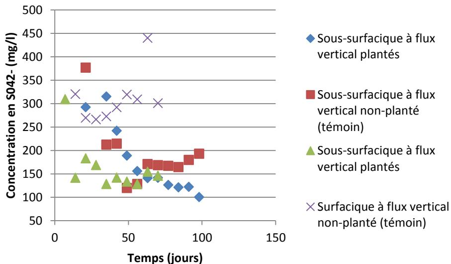
Figure 4-2 : Évolution moyenne du  $\text{SO}_4^{2-}$  dans le temps pour les marais sous-sousfaciques à flux vertical et surfaciques à flux horizontal plantés et non plantés
