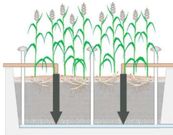
Figure 2-4 : Vue en coupe d'un marais sous-surfacique à flux vertical (tiré de Société québécoise de phytotechnologie, 2013)
