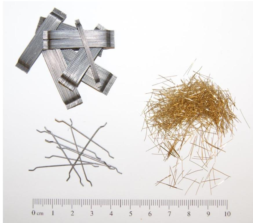
**Figure 2-1: Fibres d'acier Dramix 65/35 (gauche) et OL 10/0.20 (droite)**
