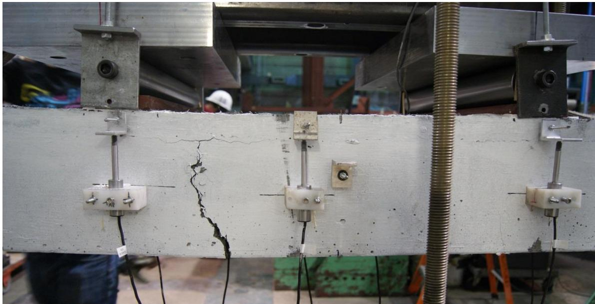
**Figure E-2 : Trois capteurs de déclaminage (dalle hybride moment positif)**
