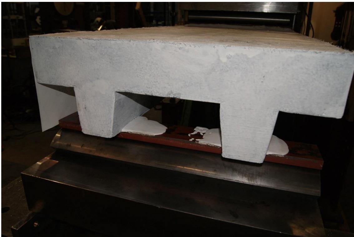
Figure E-6 : Dalle nervurée en BFUP installée sur les appuis du montage (moment positif)
