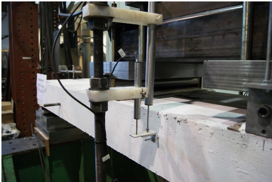
**Figure E-4 : Mesure de la flèche au centre pour les essais de fatigue**
