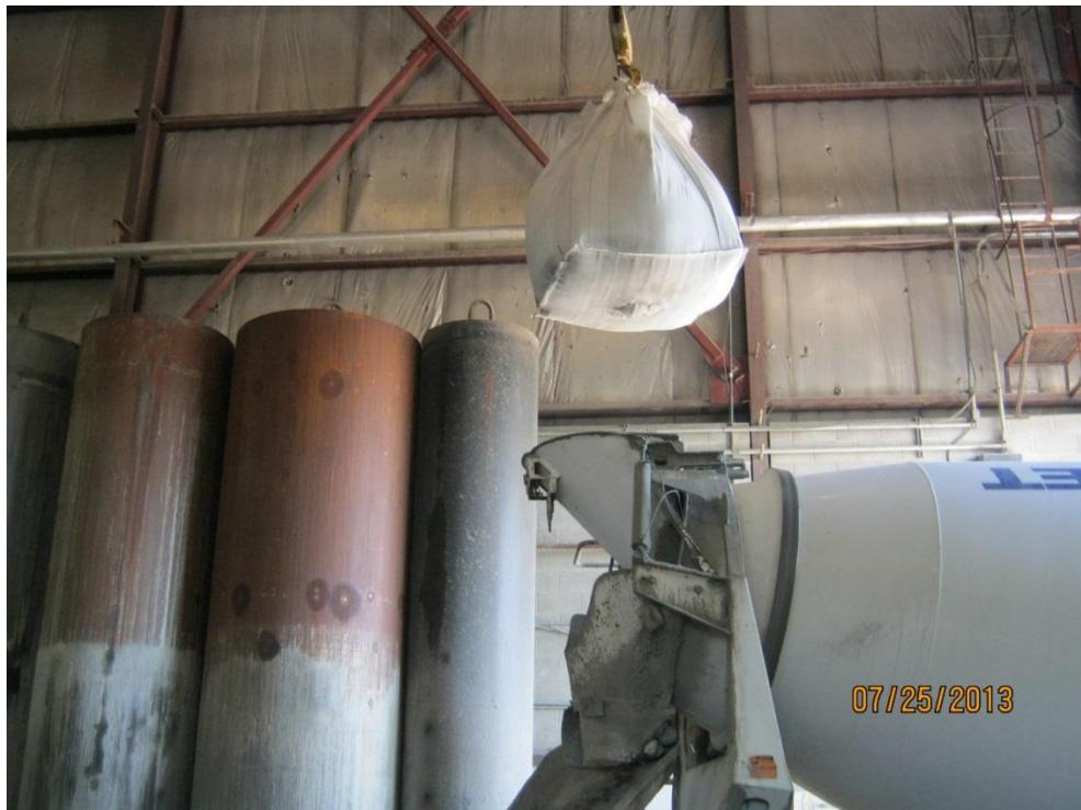
**Figure D-1 : Ajout du ciment dans le camion-malaxeur par «big bag»**
