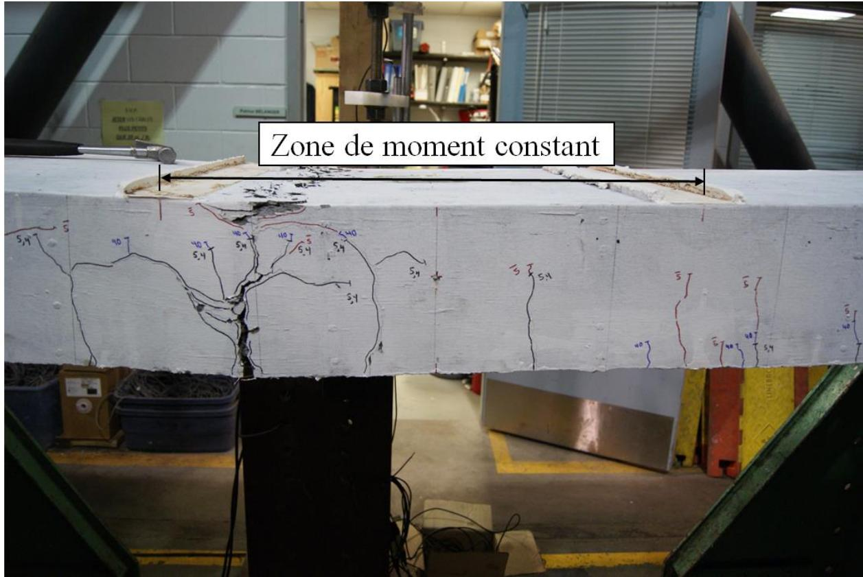
**Figure 5-5: Patron de fissuration à l'ultime de la dalle en BFHP testée en fatigue**
