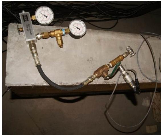
2. Valve de chargement d'azote
