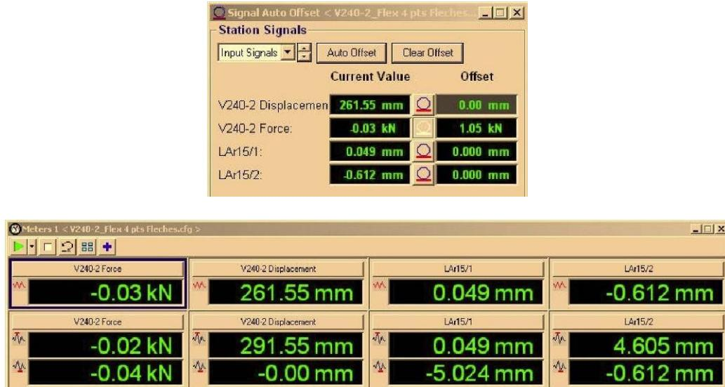
Figure C-16 : Mise à zéro des données de déplacement et des valeurs min-max
