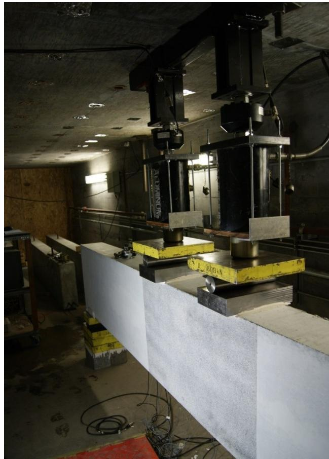
Figure 3.24 : Photo du montage de fluege flexionnel - poutres de 4 mètres
