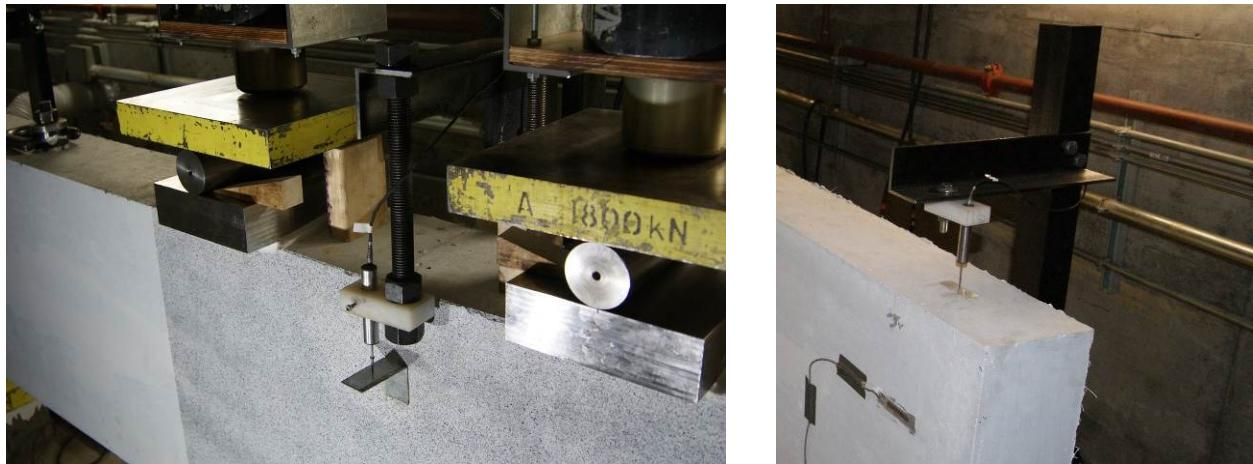
Figure 3.29: Mesure de la flèche – poutre de 4 mètres
