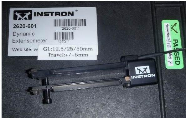
Figure C-11 : Extensomètre
