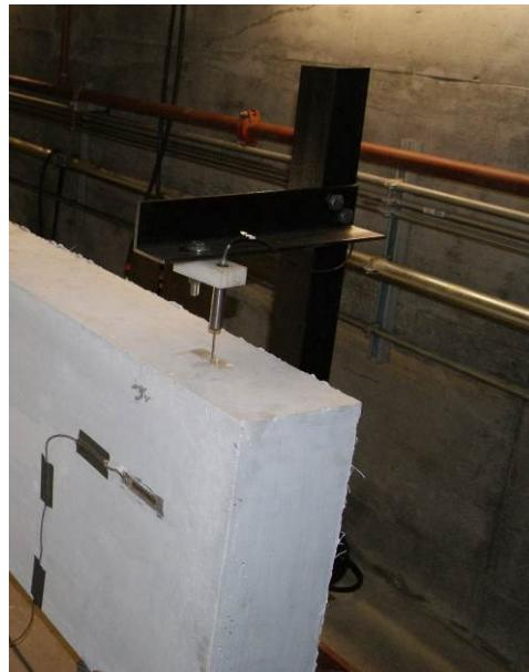
Figure E-9 : Tassement à l'appui
