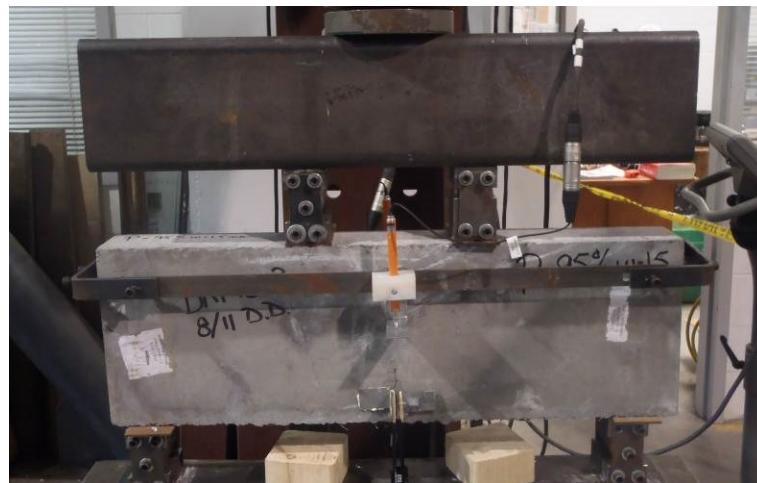
Figure C-10 : Instrumentation des flèches
