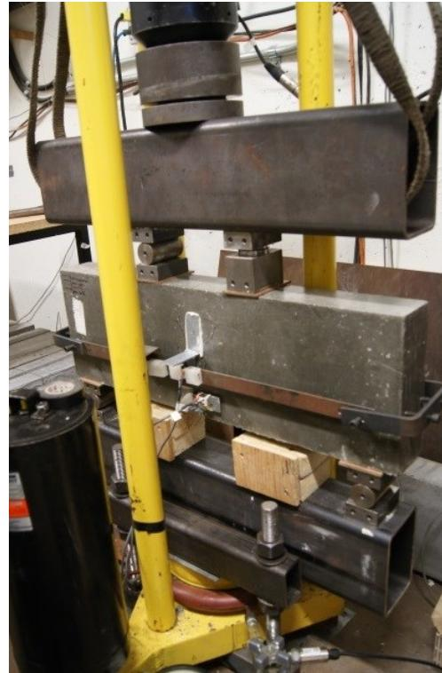
Figure 3.6 : Dispositif de fluage flexionnel
