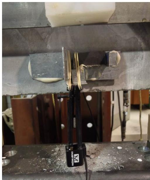
Figure C-13 : Installation d'un extensomètre
