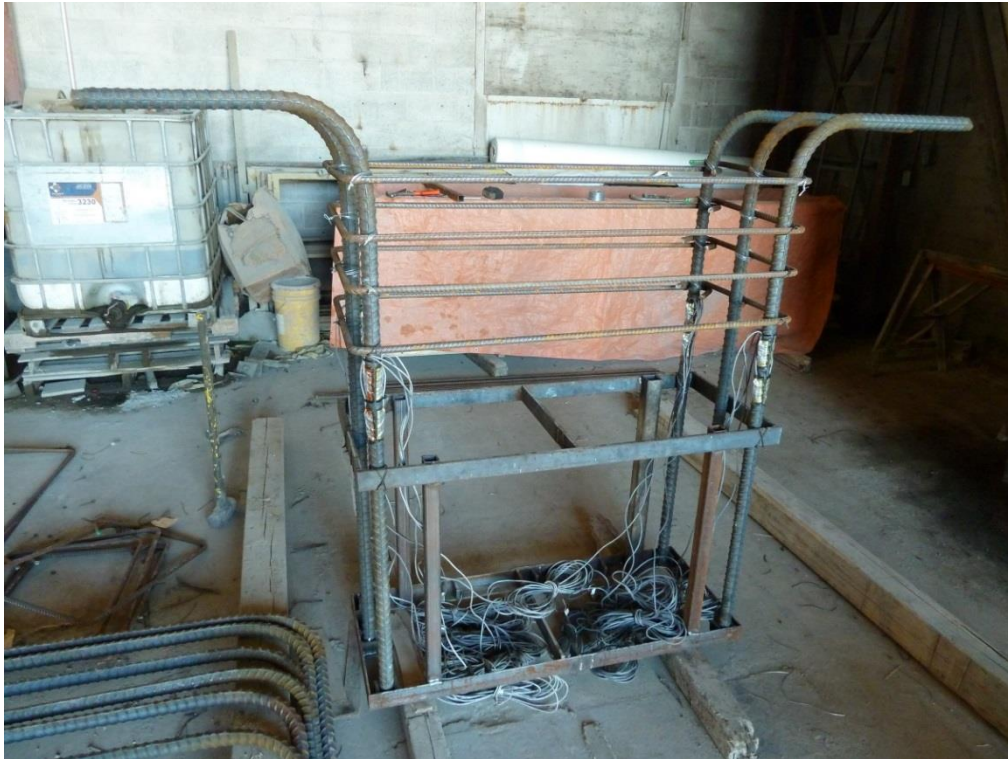
Photo 4 : Montage des barres jaugées sur le support fabriqué (5 août)
