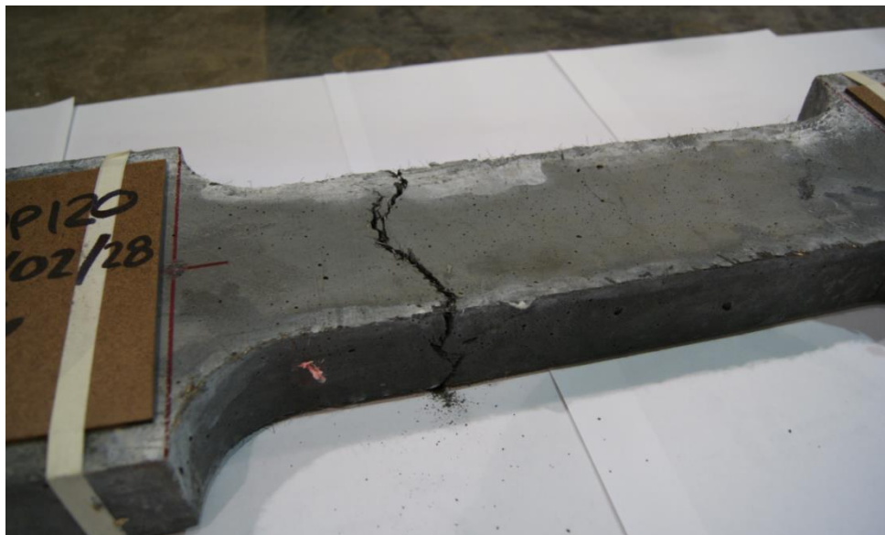
Figure 2.23 : Macrofissure dominante à la rupture (point C) suite à un essai de traction axiale sur échantillon en forme d'os
