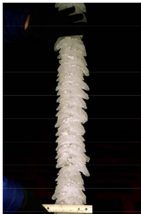
Figure 2.4 Glace sur une aile en flèche (extrait de Papadakis et al. , 2005).
