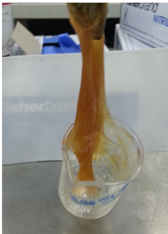
Figure A.4 Démonstration de la viscosité d'un polyelectrolyte de Gua-PVT à \sim 100^{\circ}\text{C} , à environ 50% d'eau (%w)
