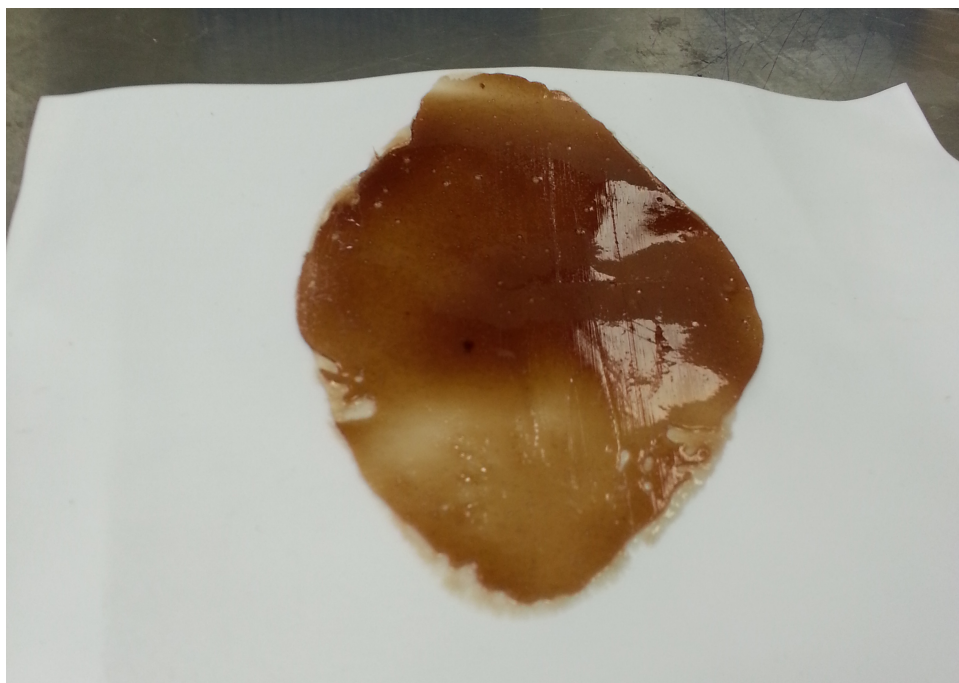
Figure A.5 Feuille de polyélectrolyte de Gua-PVT refroidie, à environ 30% d'eau
