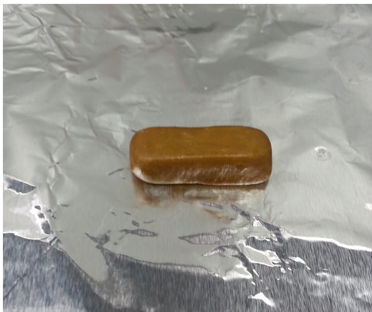
Figure 4.13 Polymère de PVT/PIA ( 17b ) mouillé, malléable
