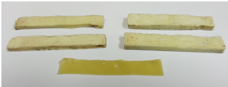
Figure 4.26 Gonflage d'éprouvettes de \text{PVT} \cdot \text{HClO}_4 , 3 incomplètes et 1 complète (+225%)
