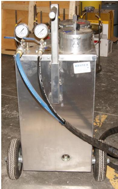
Figure 48 : Pompe à époxy à air comprimée utilisée pour toutes les injections
