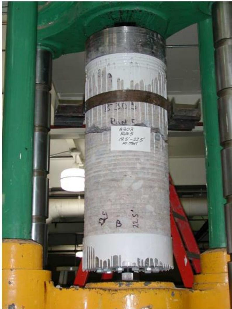
Figure 83 : Spécimen cylindrique de 18'' de diamètre de béton de barrage (Dolen, 2011)
