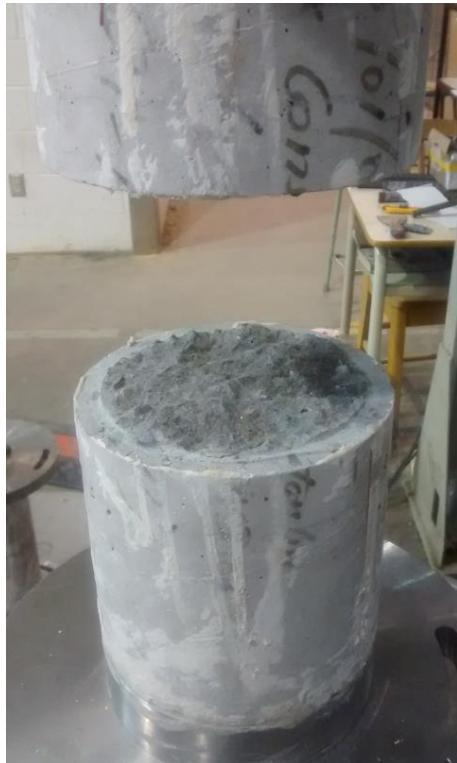
Figure 88 : Fissure du spécimen no1 suite à l'essai supplémentaire
