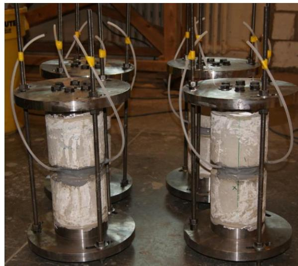
Figure 56 : Spécimens mis en place pour l'injection
