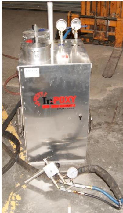
Figure 47 : Pompe à époxy à air comprimée utilisée pour toutes les injections
