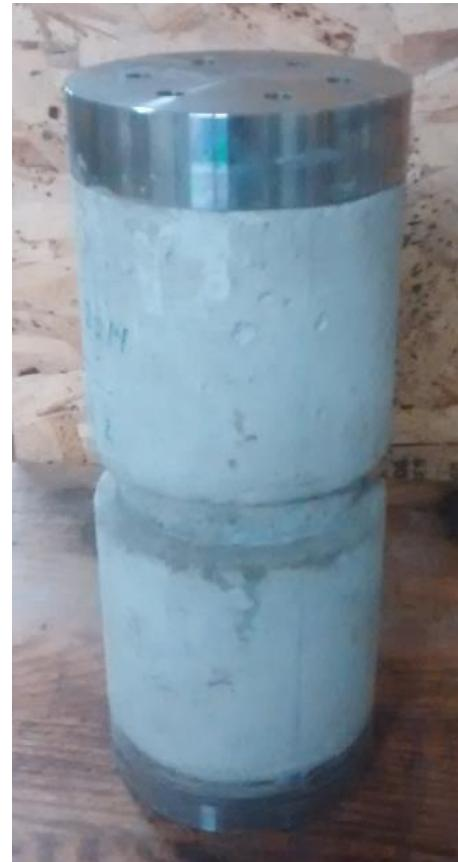
Figure 40 : Spécimen après collage des plaques d'acier de 6'' de diamètre
