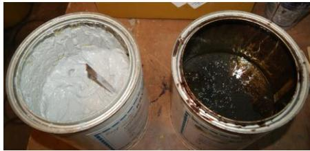
Figure 53 : Époxy scellant pour colmatage de la fissure
