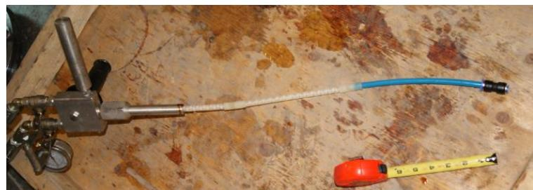
Figure 55 : Pistolet d'injection, mixeur statique et bague liant le mixeur statique et le tube d'injection
