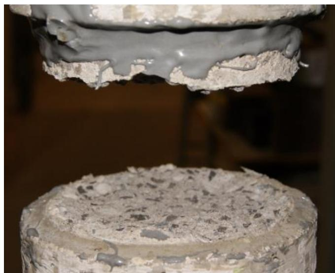
Figure 57 : Rupture de type 1 (Réparation réussie et comportement en traction directe typique)
