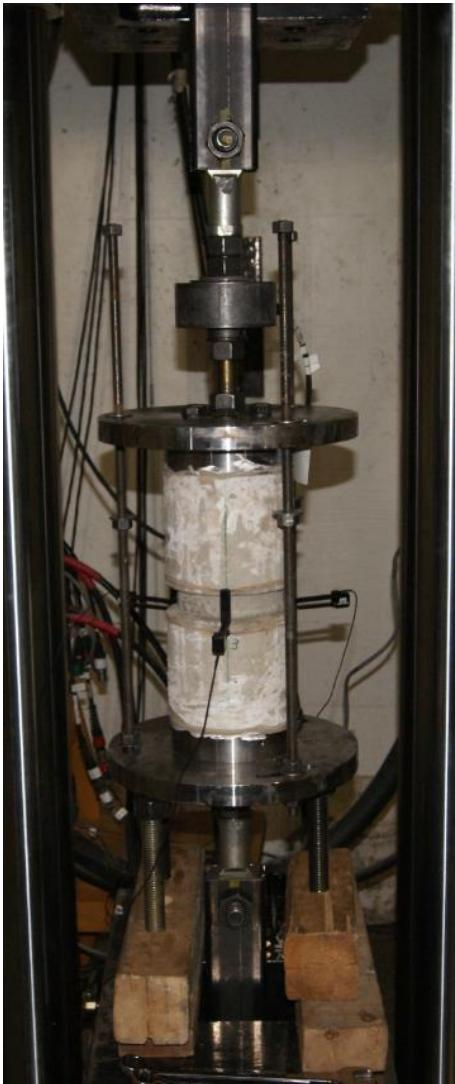
Figure 43 : Montage d'essai en traction directe
