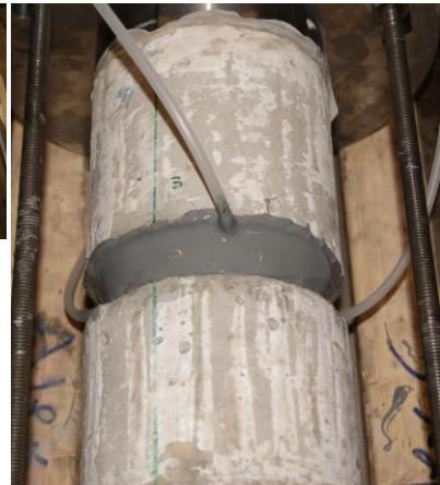
Figure 54 : Colmatage de la fissure avec l'époxy scellant
