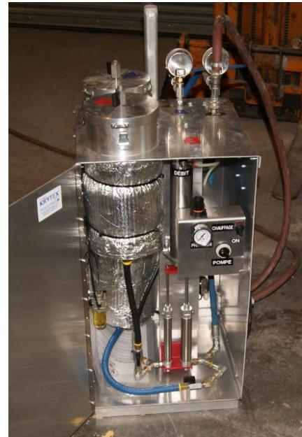
Figure 49 : Pompe à époxy à air comprimée utilisée pour toutes les injections
