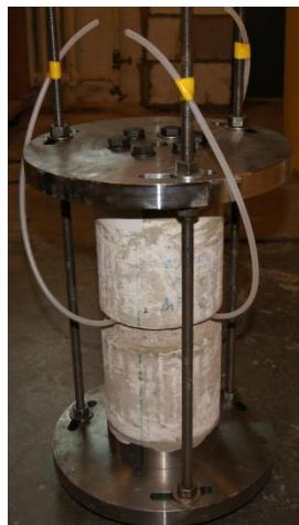
Figure 51 : Insertion des 3 tubes d'injection dans les trous percés dans la fissure
