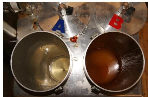
Figure 46 : Composantes (A et B : Résine et durcisseur) de l'époxy B dans les réservoirs de la pompe
