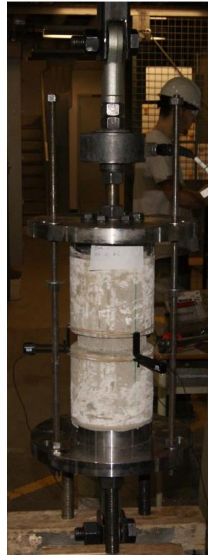
Figure 44 : Montage d'essai en traction directe
