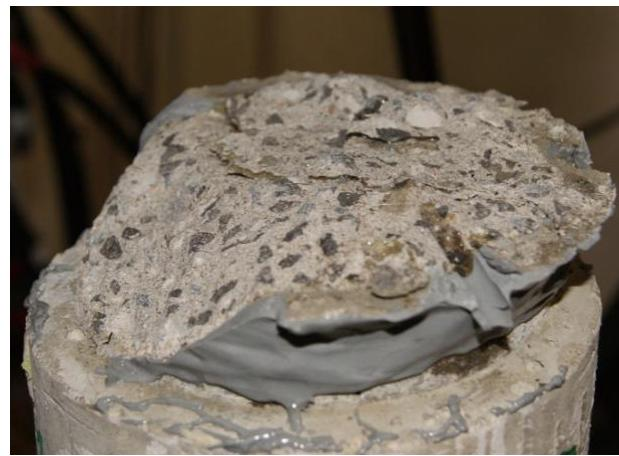
Figure 60 : Rupture de type 4 (Traces d'époxy durci)
