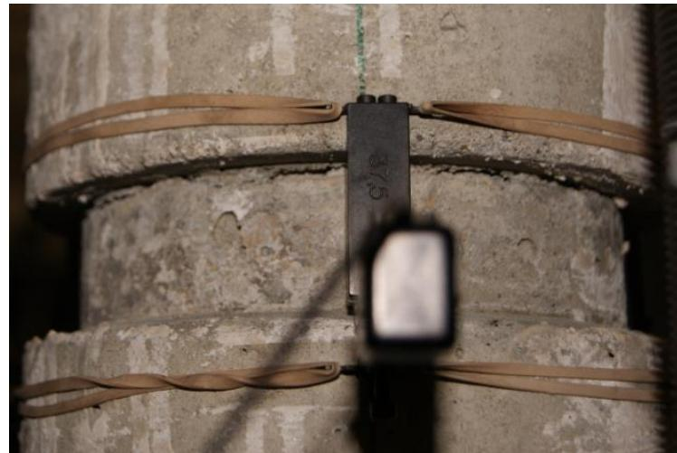
Figure 41 : Fissure de retrait d'un spécimen dans le haut de l'encoche avant le début de l'essai
