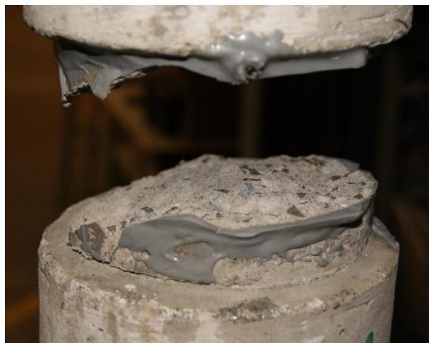
Figure 58 : Rupture de type 2 (Effet de flexion important dès le début de l'essai, combiné à la présence d'une seconde fissure de retrait, à une faiblesse importante dans section ou à une excentricité du montage d'essai)
