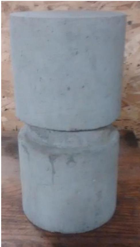
Figure 39 : Spécimen après surfaçage des extrémités
