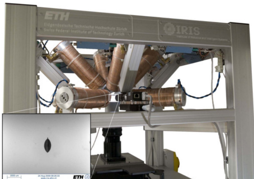
Figure 1-10 – Composé de huit bobines électromagnétiques, le système Octomag permet de contrôler un microrobot (encadré en bas à gauche) avec cinq degrés de liberté. Extrait de [92].
