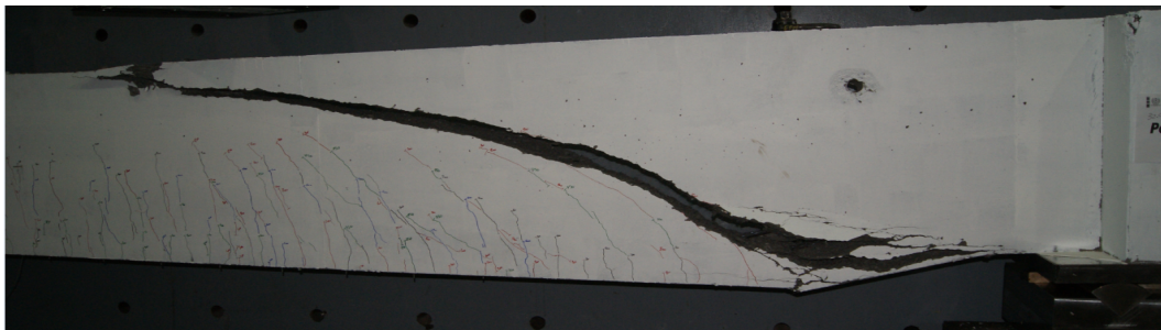
(d) Shear failure of specimen R03
