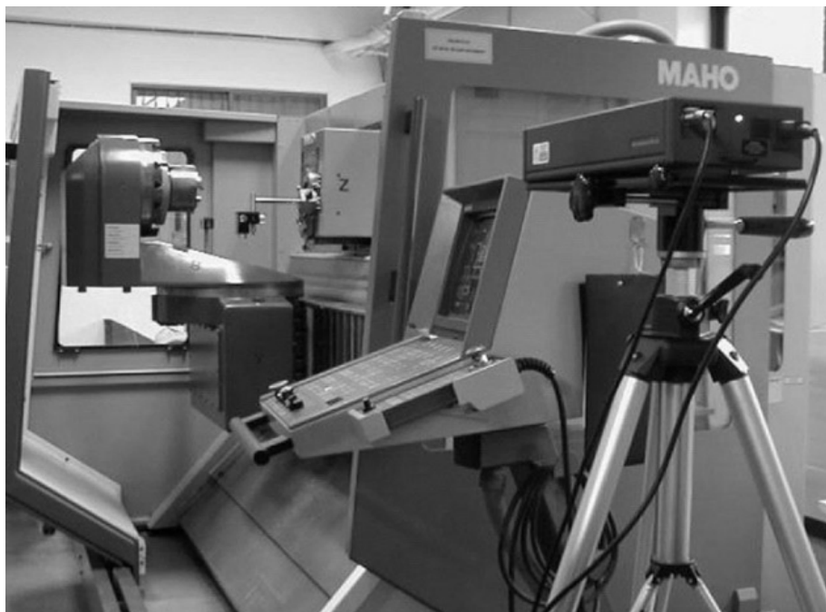
Figure 1-4 : Mesure directe par interféromètre laser [10]
