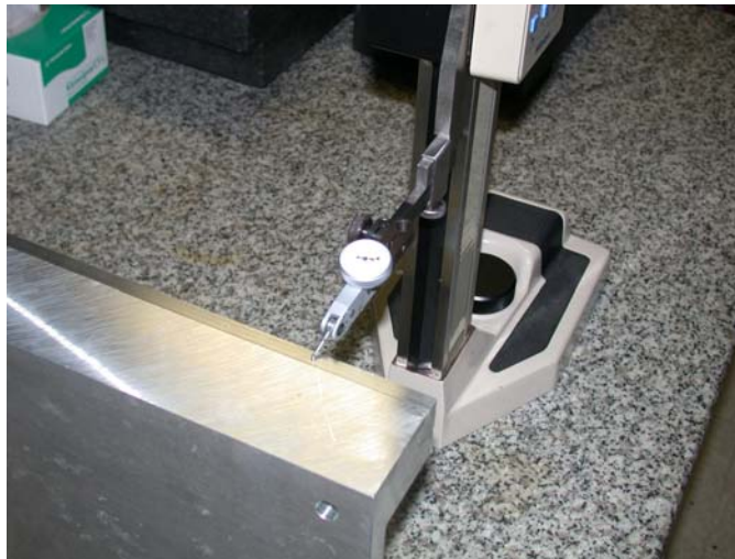
Figure 3-8: Comparateur utilisé pour vérifier le défaut de forme linéaire.
