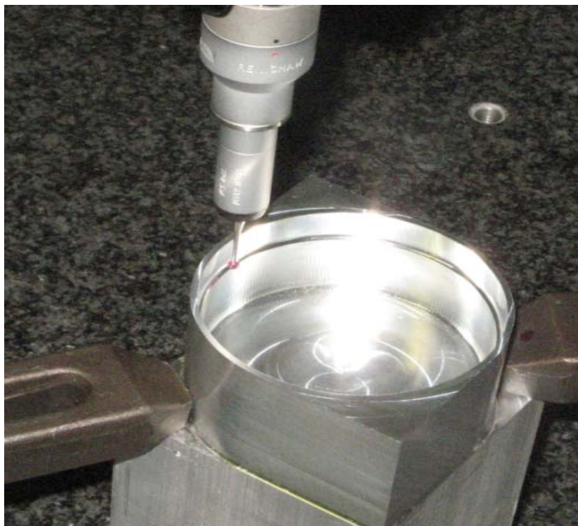
Figure 3-2: Deuxième pièce utilisée pour les tests expérimentaux : paroi circulaire.
