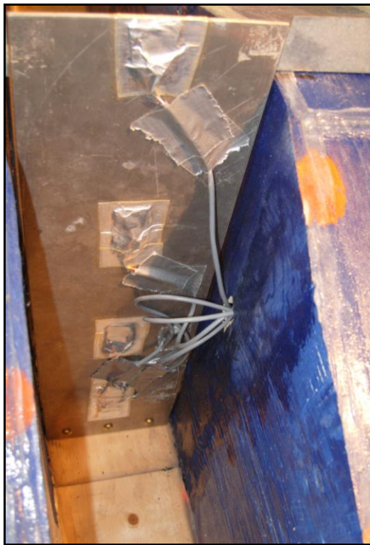
Figure A.4 : Introduction des fils dans le caisson (ouverture 1).
