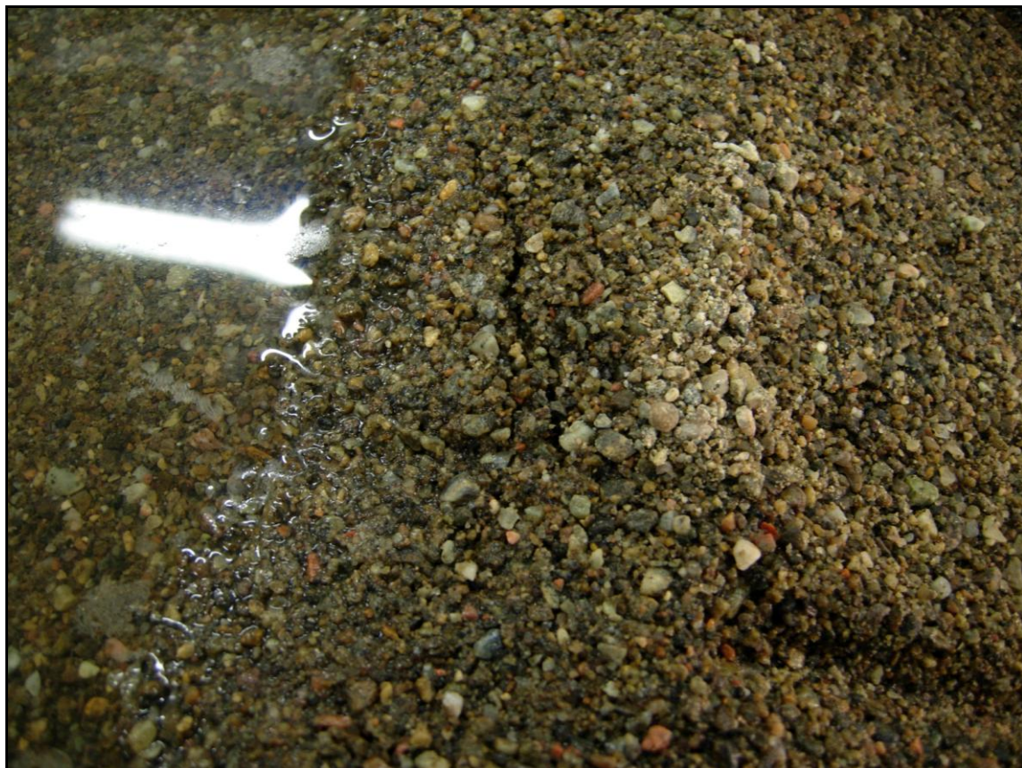
Figure A.15 : Fissuration de la crête causée par la montée des eaux.
