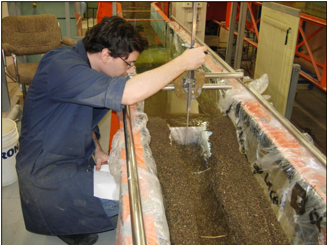
Figure A.20 : Mesure des profondeurs d'érosion au moyen d'une pointe droite.
