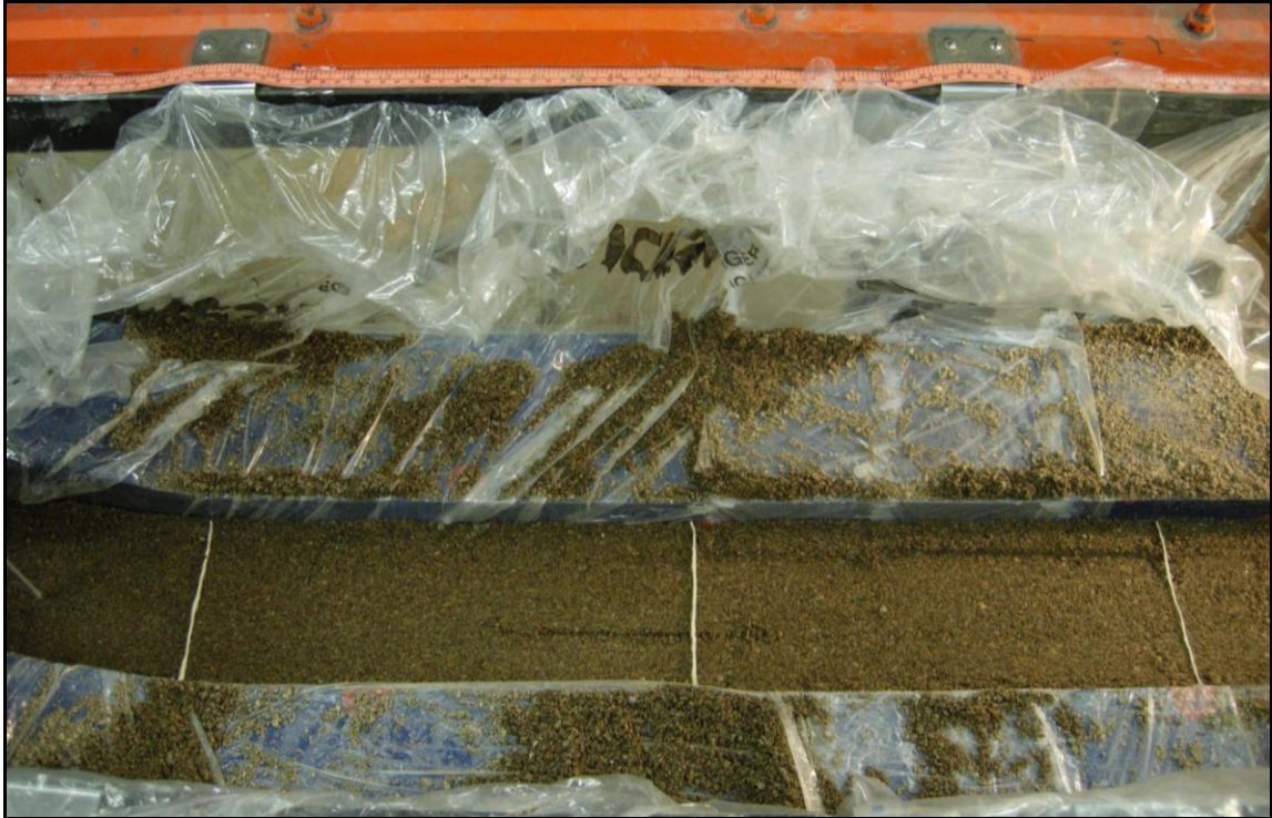
Figure A.9 : Positionnement des marqueurs d'érosion le long du replat.
