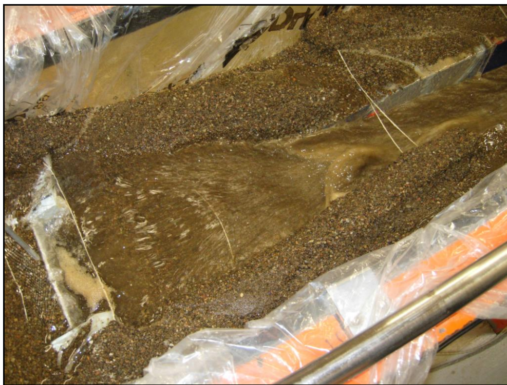
Figure A.19 : Progression de l'érosion le long du talus et du replat à l'aval.
