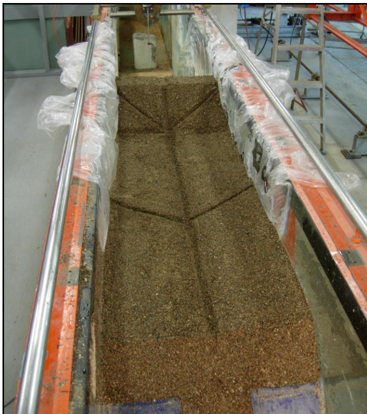
Figure A.10 : Tracé des sillons initiateurs d'écoulement le long du talus et du replat à l'aval.
