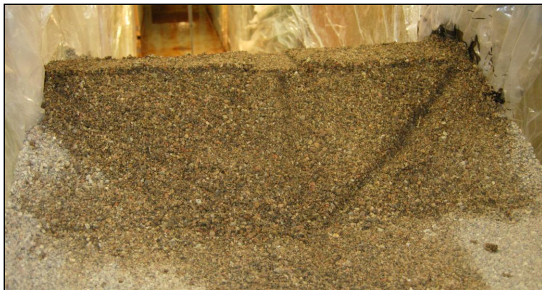
Figure A.11 : Encoche à la crête sur une largeur de 4,5 cm.
