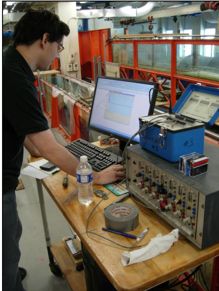
Figure A.6 : Lecture et enregistrement des microdéformations.
