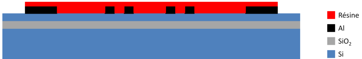
Image 5) Gravure de l'Aluminium : Gravure chimique du masque d'aluminium pour atteindre la couche de Si.
