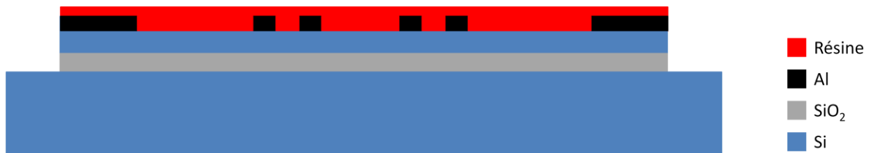
Image 7) Gravure du \text{SiO}_2 : Gravure chimique du \text{SiO}_2 pour atteindre le substrat.
