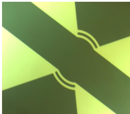
Figure 4.5 : Image expérimentale du Lift-Off. Un canal microfluidique et des miroirs de Bragg sont illustrés
