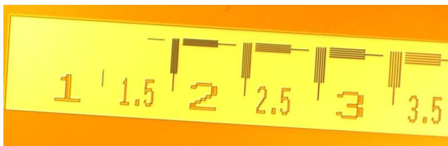
Figure 4.6 : Marque de résolution de la deuxième photolithographie avec la résine SPR 7.0.
