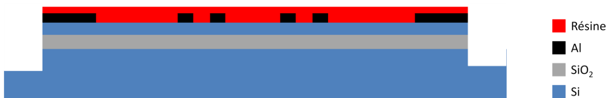
Image 8) Deuxième DRIE : Gravure partielle des tranchées optiques.
