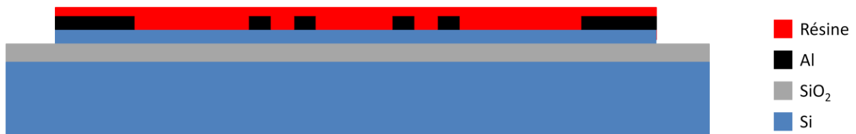
Image 6) Première DRIE : Gravure partielle des tranchées optiques.
