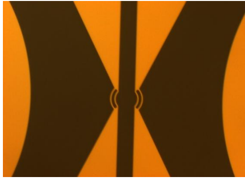
Figure 4.7 : Résultats de la deuxième photolithographie. Un canal microfluidique, des lentilles de silicium et des miroirs de Bragg sont illustrés
