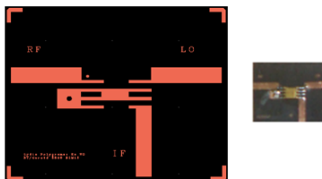
FIG 4.31. Masque et photographie du mixeur (HMC129G8)
